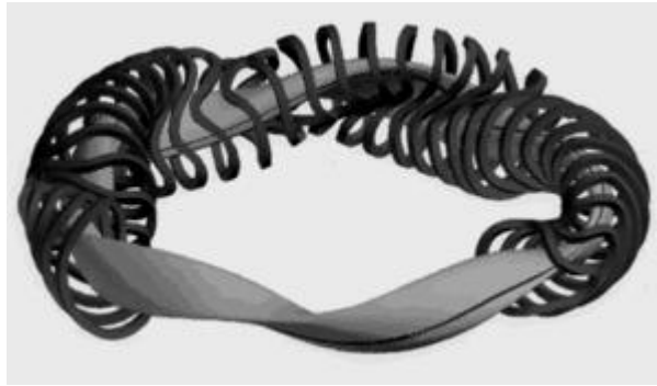
Fig. 6.8 Trayectoria del plasma en el interior de un STELLARATOR.
