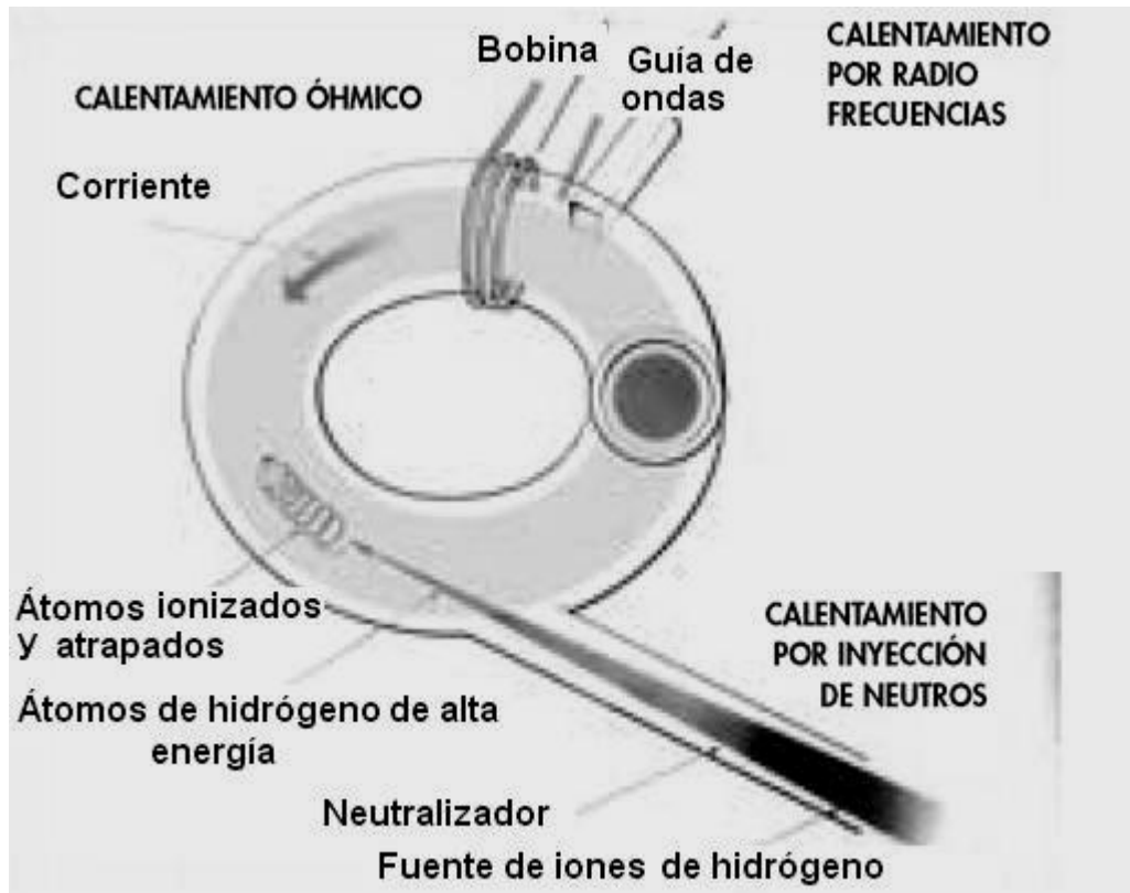
Fig. 6.9 Tres diferentes métodos externos al plasma que sirven para calentar a éste.
