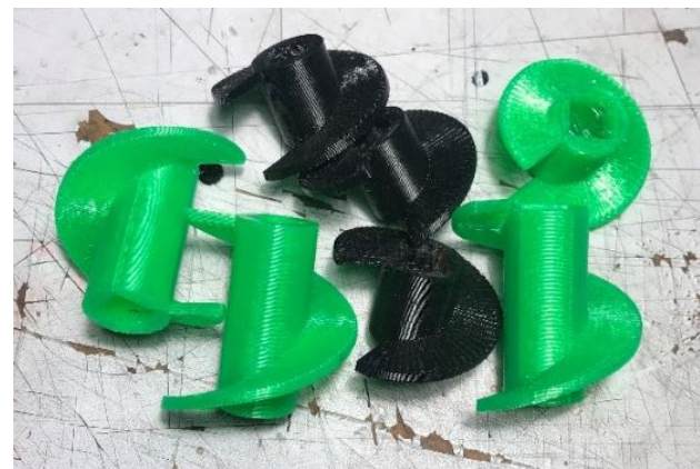
Imagen 66. Tornillos de extrusión tipo 1 y 2. Esteban Pérez de León. 2022
