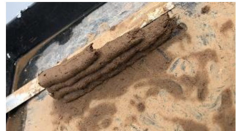
Imagen 83. Extrusión para pruebas. Esteban Pérez de León. 2022
