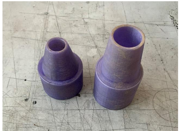
Imagen 77. Boquillas de 20 y 30 milímetros. Esteban Pérez de León. 2022
