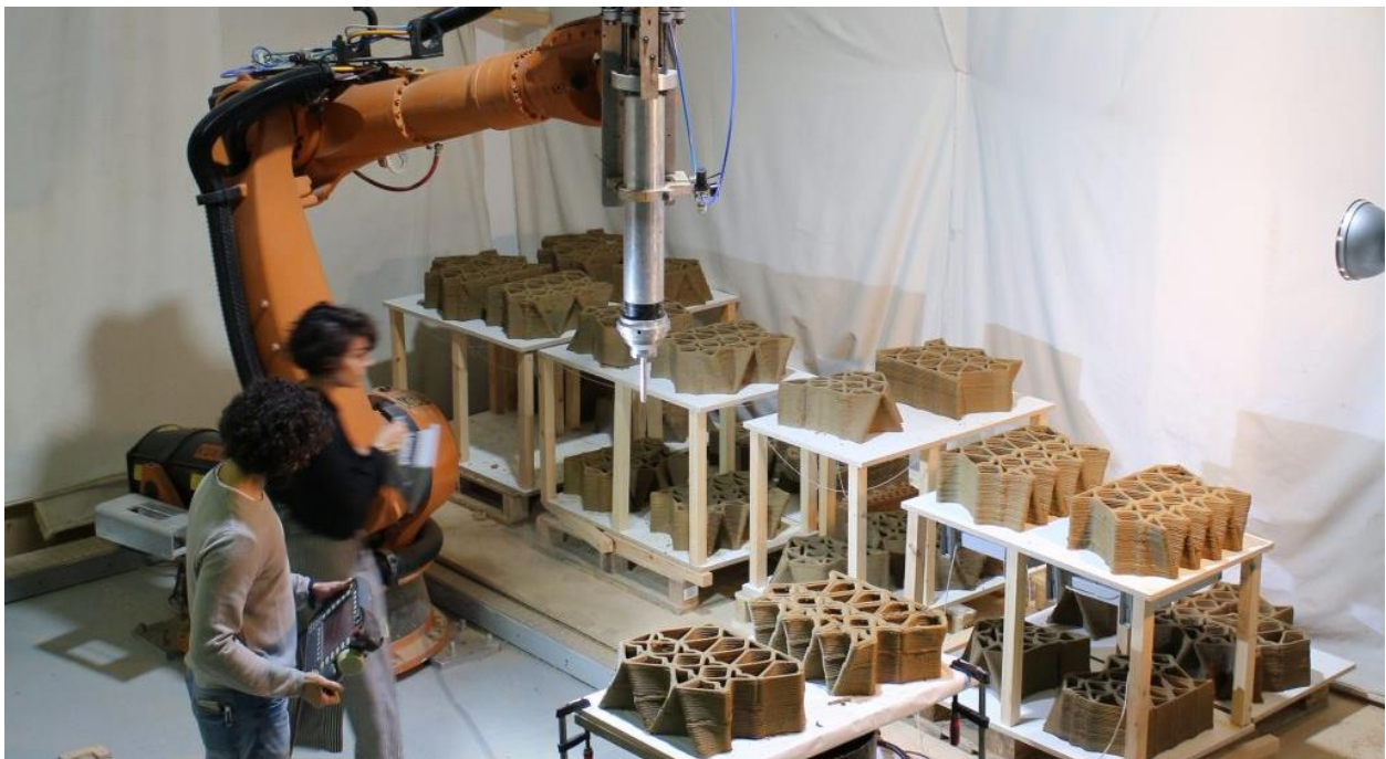
Imagen 28. Proceso de impresión de módulos para proyecto Terra Performa. I.A.A.C. – O.T.F.2017
