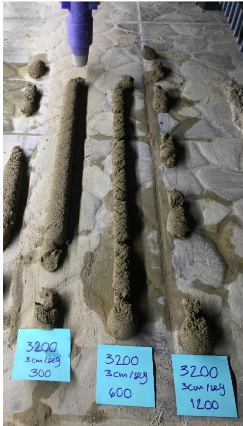
Imagen 88. Comparación entre velocidades de extrusión y desplazamiento. Esteban Pérez de León. 2022
