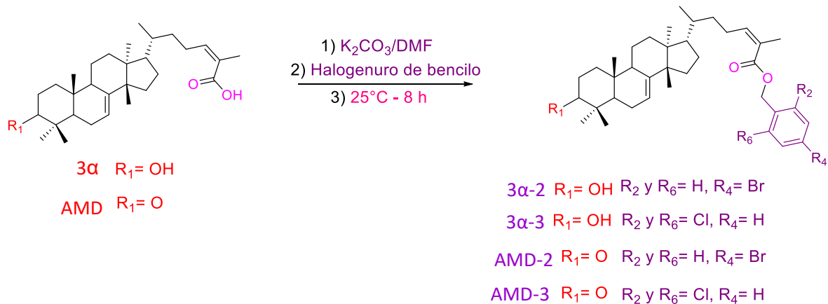
Figura 21. Síntesis de ésteres masticadienato e hidroximasticadienato de p -bromobencilo y masticadienato de 2,6-diclorobencilo a partir de 3\alpha y AMD. ( Compuestos AMD-2 y AMD-3, y 3\alpha-2 y 3\alpha-3 ).
