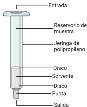
Figura 13 Estructura de una columna típica de Cromatografía en Fase sólida.
