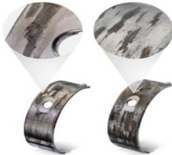
Figura 17.- Marcas de desgaste por fricción en cojinetes de auto Nota: Figura tomada de "RHEINMETAL"
