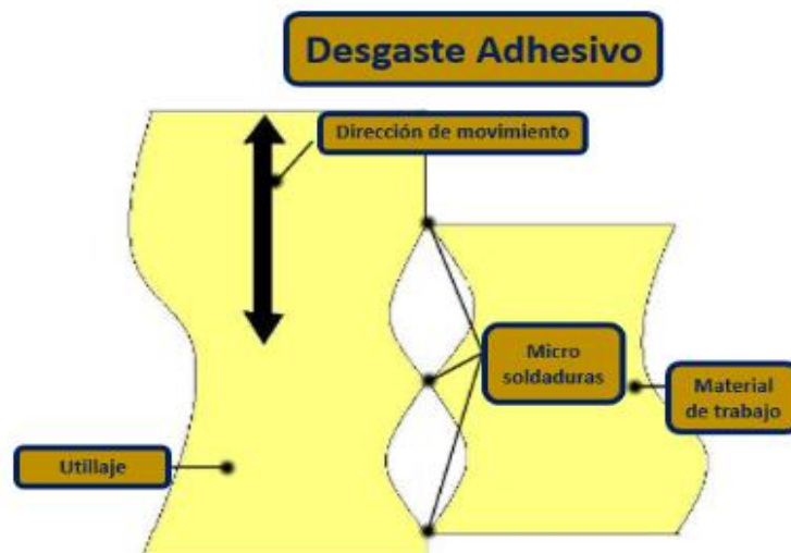
Figura 18.- Demostración de desgaste adhesivo Nota: Imagen tomada de (Wikimedia commons, s.f.)
