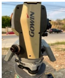
Fig.21 Estación total marca Gowin.
