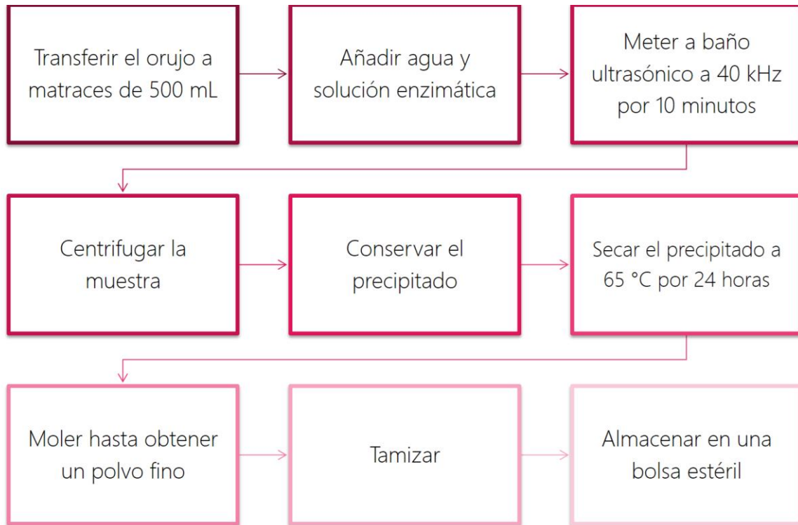
Figura 18. Diagrama para el pretratamiento del orujo (elaboración propia)
