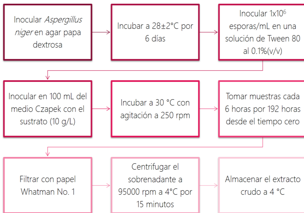
Figura 19. Diagrama para la fermentación sumergida, utilizando el orujo como sustrato
