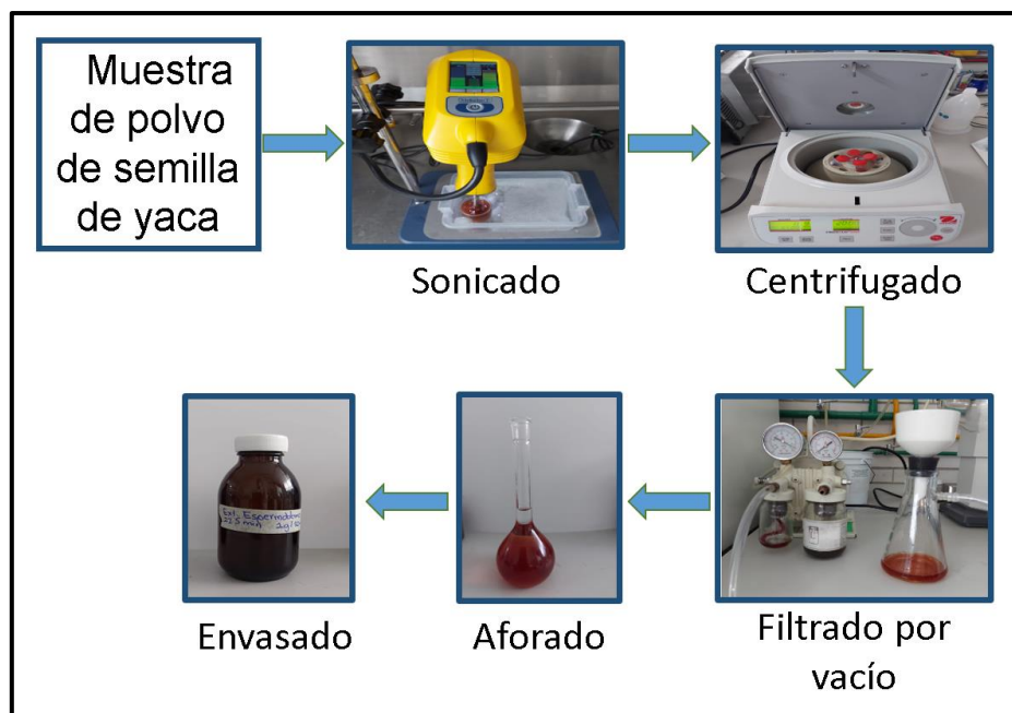
Figura 20. Extracción de compuestos fenólicos a partir de la semilla de yaca.
