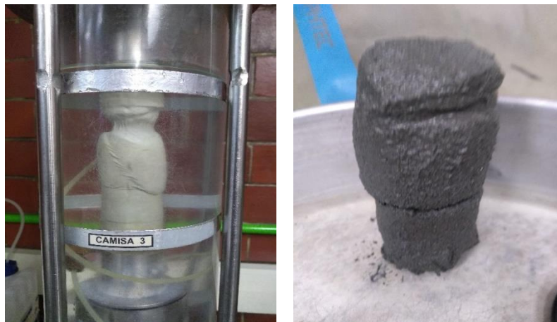
Figura 5.25. Falla de la muestra Jal3 28 días de curado a \sigma_c = 150 kPa
