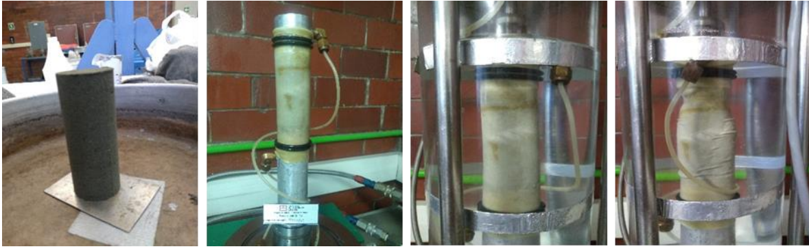
Figura 5.19. Secuencia del ensaye CU de la probeta de JalN a \sigma_c = 150 \text{ kPa}
