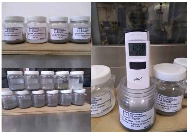
Figura 3.7. Prueba Eades & Grimm para la obtención del porcentaje óptimo de CaO
