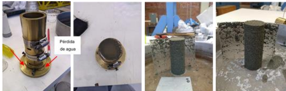
Figura 5.6. Formación de los puntos finales de la rama húmeda de la curva de compactación
