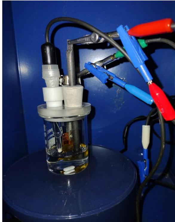
Figura 18. Celda de trabajo para voltamperometría.
