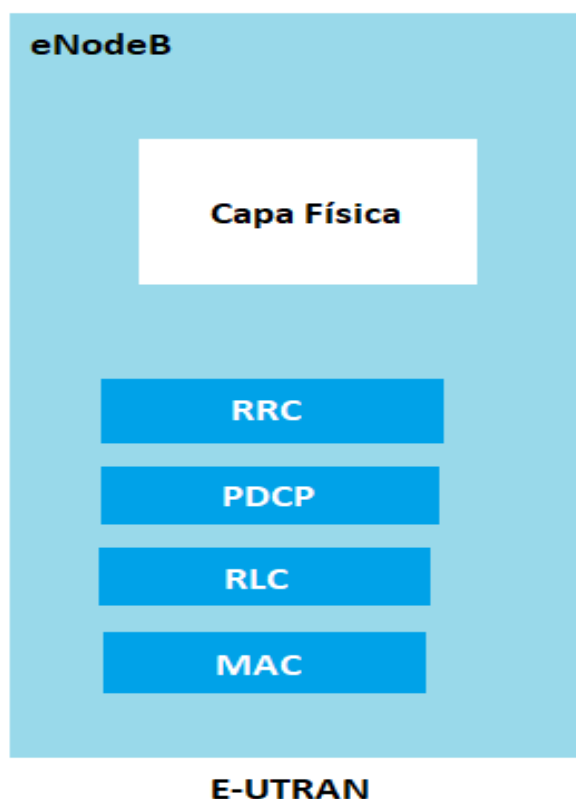
Figura 3.3 Protocolos de la capa de enlace de un eNodeB. [17]
