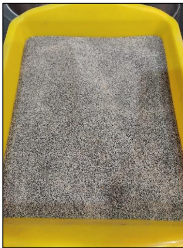
Figura 22. Cabeza de la mezcla mineral de arenas ferrotitaníferas con tamaño de partícula en número de malla 100.
