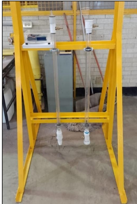
Figura 50. Elutriador nuevo instalado en el laboratorio de Beneficio de Minerales.
