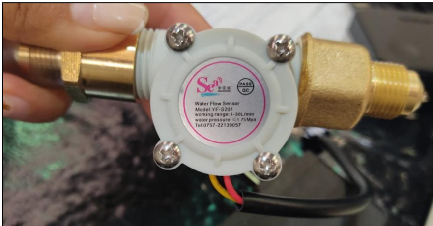
Figura 17. Sensor de flujo de agua YF-S201 con adaptadores hembra en los extremos.
