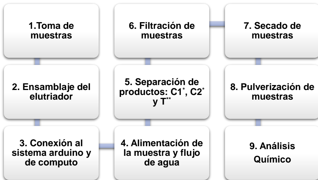
Figura 19. Diagrama de flujo para la concentración gravimétrica por medio del elutriador propuesto.
