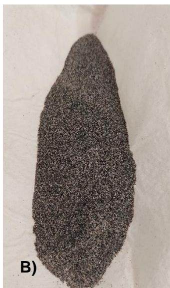
Figura 23. Productos obtenidos al operar el elutriador construido A) C1, B) C2 y C) T2.
