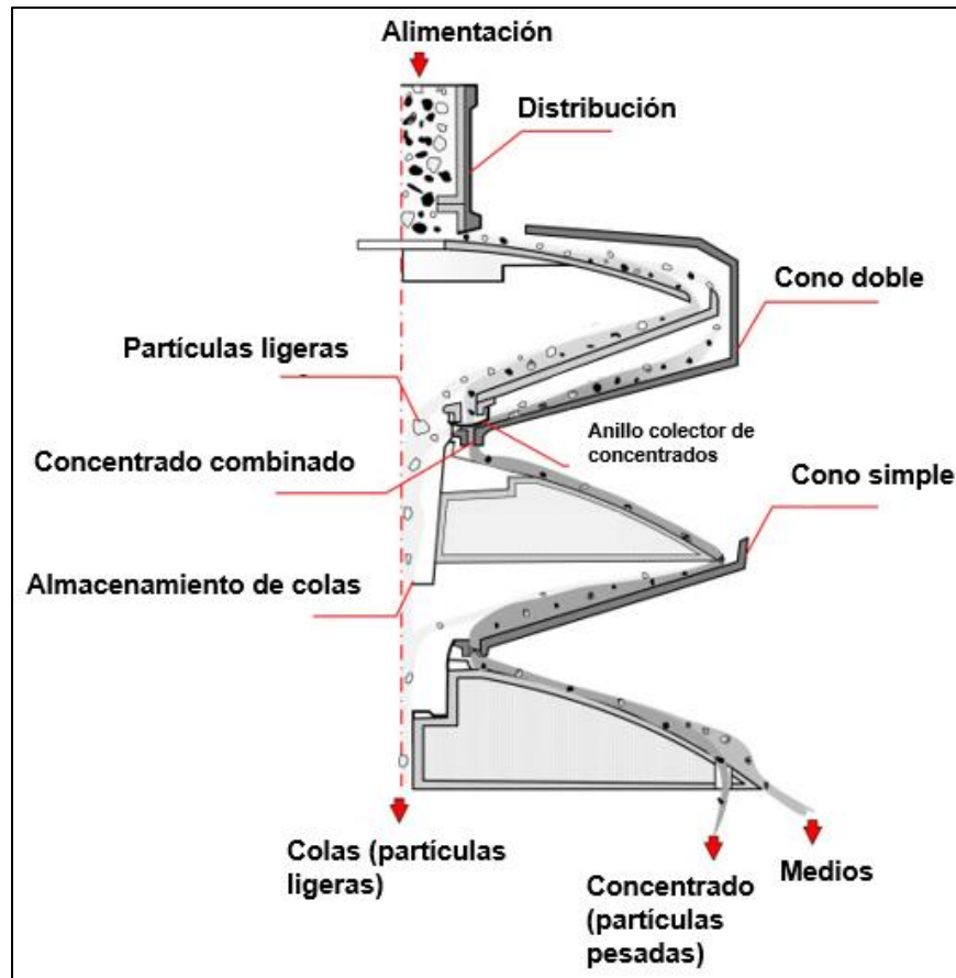
Figura 4. Concentrador de cono Reichert [5] .
