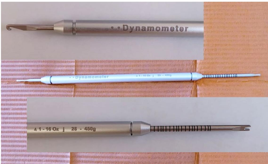
**Figura 32.** Extensómetro o dinamómetro de ortodoncia. Fuente directa.
