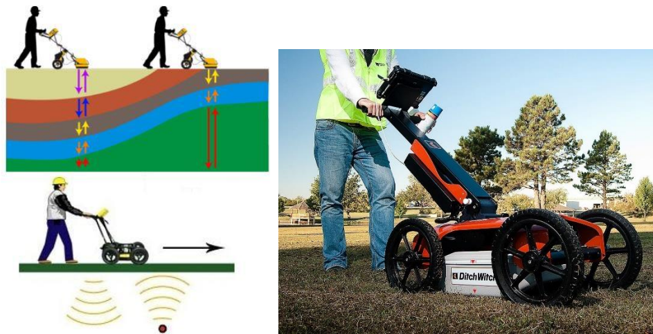
Fig. 7 Ejemplos de aplicación de radares de penetración terrestre, izquierda por CartoMex, 2025, ( https://www.cartomex.com/georadar-gpr.html ) derecha Man using a ground penetration radar, Ditch Witch, 2010, Flickr ( https://upload.wikimedia.org/wikipedia/commons/thumb/2/29/Ground_Penetrating_Radar_in_use.jpg/800px-Ground_Penetrating_Radar_in_use.jpg )
