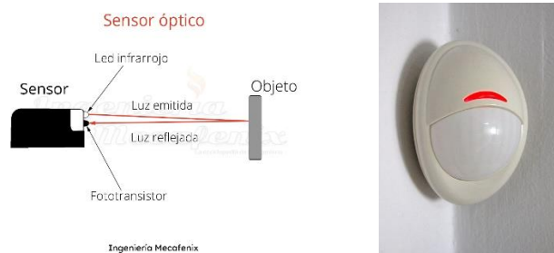
Fig. 11 Ejemplos de detectores de movimiento optoelectrónicos, domoticaintegrada.com/sensor-de-movimiento y Sensor infrarrojo pasivo Visonic, 2016 , (Wikimedia commons https://commons.wikimedia.org/wiki/File:PIR_Sensor_Visonic_Next%2BMCW.jpg )
