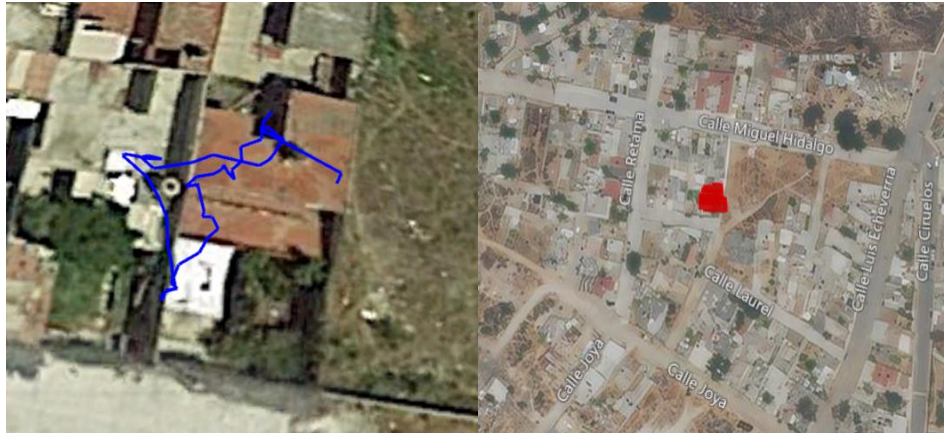
Fig. 59 De izquierda a derecha: trazos generados con GPS teléfono móvil, trazo generado con GPS NEO (Mapas obtenidos de Google® Earth y Bing® Maps).
