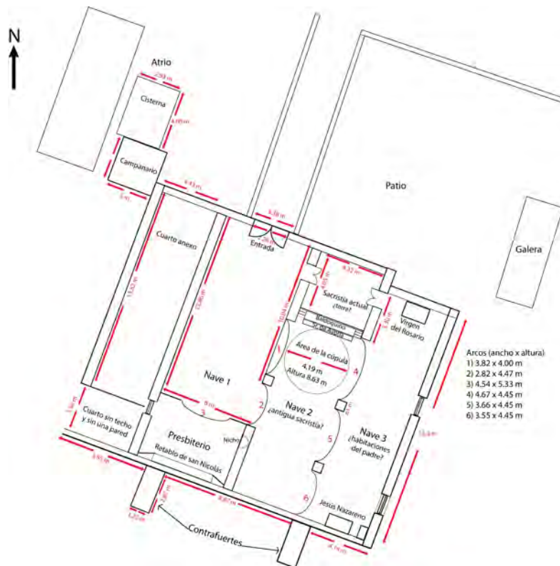
Fig. 11. Planta de la capilla de San Nicolás de Ayotla, Oaxaca. Medición: Bulmaro Bazán y Juventino Gómez Marín, elaboración: Vanessa Santiago, 2022. Las mediciones internas y externas fueron tomadas con un distanciómetro láser, por lo que existe un margen de error mínimo en las dimensiones.
