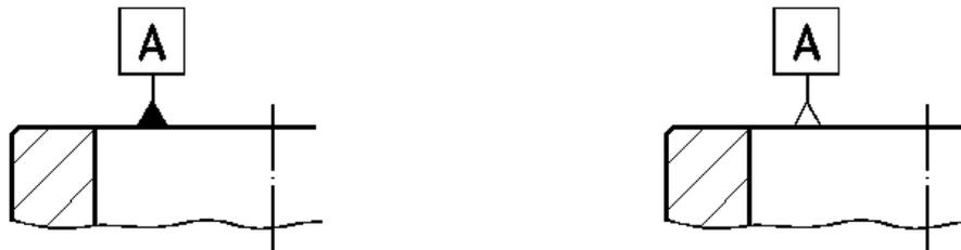
**Figura 2.31. Indicación de la referencia sobre un contorno.**
