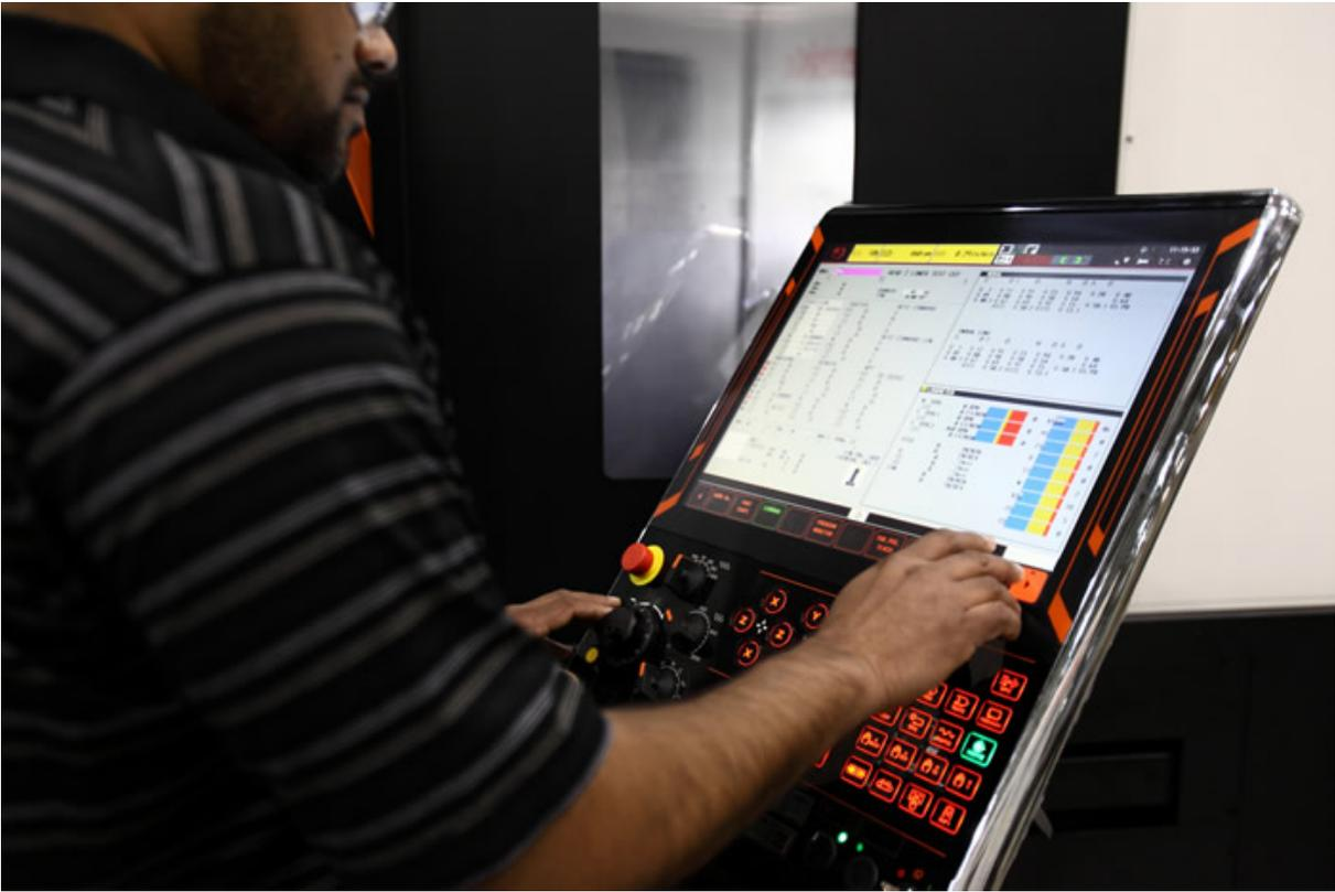
*Figura 2.43. Programación a pie de máquina Panel de Control MAZAK*
