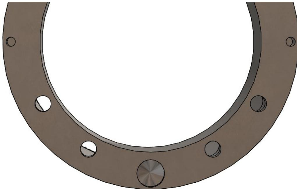
**Figura 4.15. 2X Ø1.2 mm con J3 mm y barreno de Ø3.78 mm**
