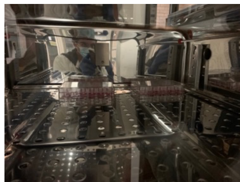
Figura 26. Cajas de cultivo dentro de la incubadora a 38°C con una atm6sfera de 5% de CO 2 .
