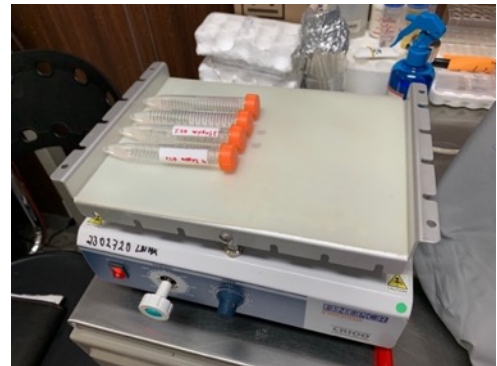
Figura 23. Homogenizado continuo de las muestras para la digestión enzimática con 0.25% de tripsina-EDTA.
