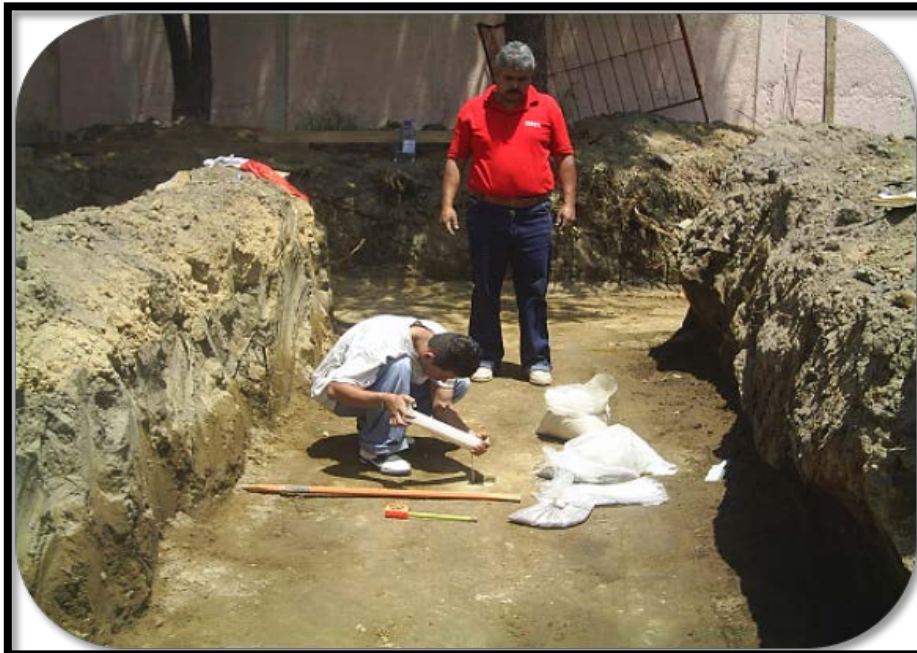
Imagen 3.8. Las pruebas de compactación que se realizaron en campo reflejaron resultados aceptables.
