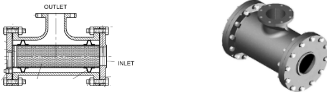
Figura 26.- Filtro de Sistema de Diluvio
