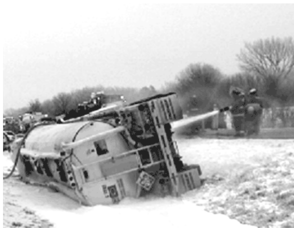
Figura 19.- Espuma usada en derrame de combustible
