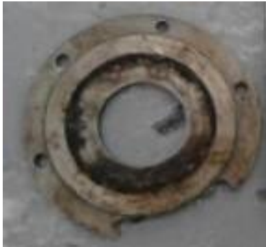
Imagen 52 – Muestra sección de la tapa rota del alojamiento.
