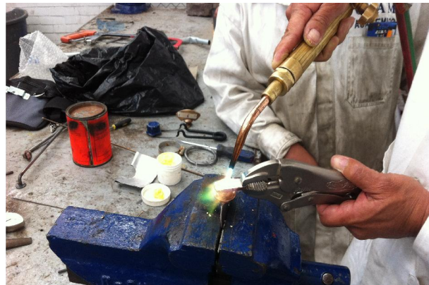
Imagen 79 – Se puede ver el proceso de soldadura en uno de los álabes.
