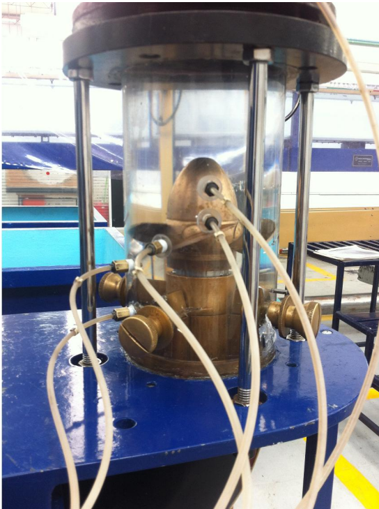
Imagen 103 – Se muestra a la turbina, el cubo de acrílico, álabes y mangueras que van a los manómetros en el tablero principal.
