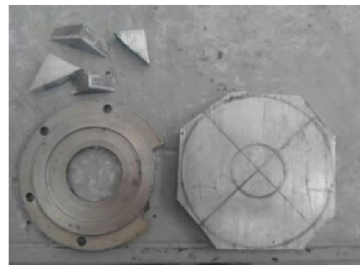
Imagen 85 – Corte del material excedente y centro en la pieza de aluminio.
