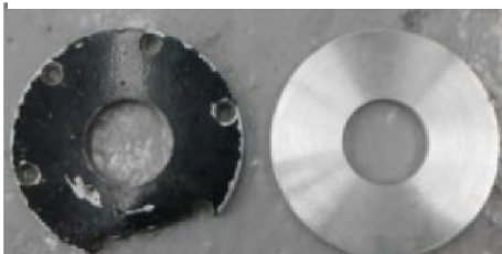
Imagen 89 – Se observa a la tapa parcialmente terminada.
