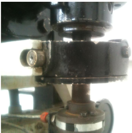
Imagen 36 – Se observa al sujetador (arriba) y alojamiento de balero (en medio), acoplamiento entre eje y motor (abajo).
