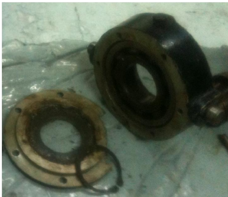
Imagen 68 – Se observa a la tapa y balero a reemplazar dentro del elemento que lo aloja (derecha).
