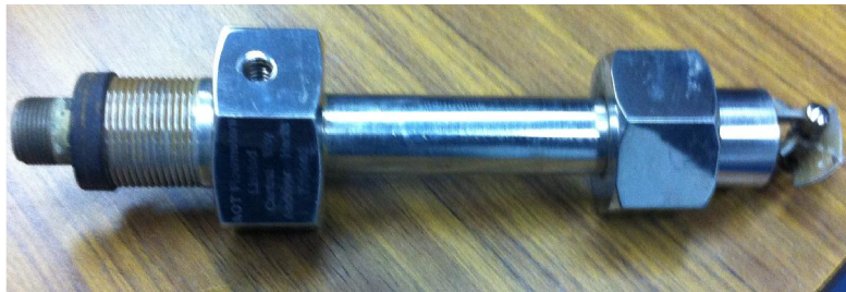
Imagen 8 – Se observa al medidor de flujo desacoplado de la placa de aforo.
