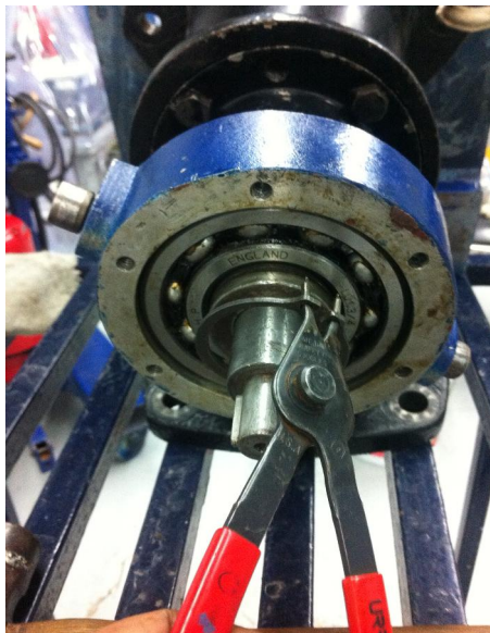
Imagen 94 – Se observa al balero nuevo en su alojamiento y la herramienta de trabajo.
