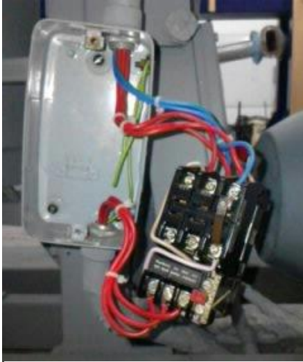
Imagen 51.- Muestra el interior de la botonera y sus elementos.
