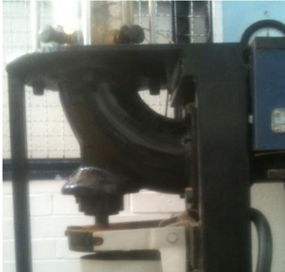
Imagen 4 – Se puede observar el codo de hierro fundido a 45° acoplado al sistema hidráulico.
