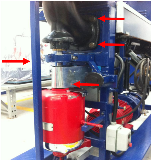
Imagen 111 – Se señalan los tornillos y la barra vertical a retirar para desmontar la turbina.
