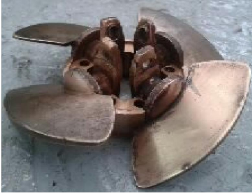
Imagen 9 – Muestra los álabes desmontados del rodete y del eje de la turbina.
