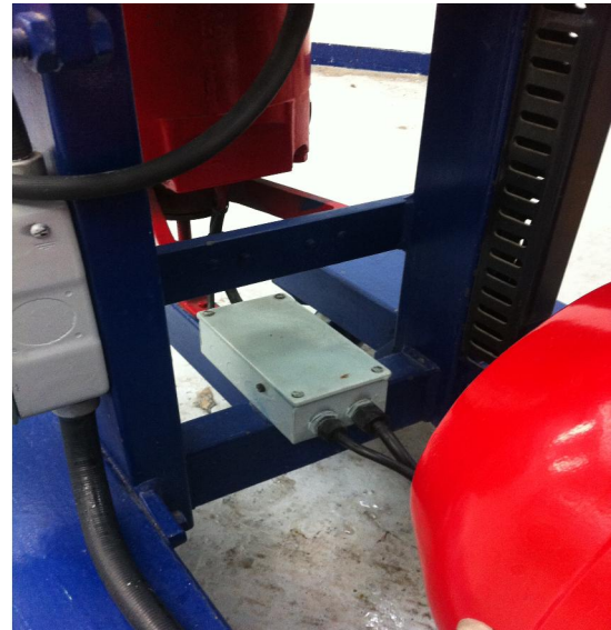
Imagen 110 – Modulo de interconexión entre el motor y la unidad de control.
