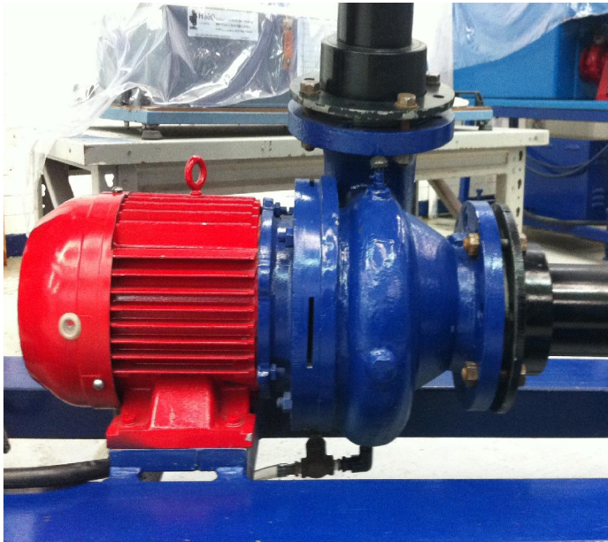
Imagen 106 – Bomba (en rojo) y carcaza o voluta (en azul) conectada al sistema hidráulico.
