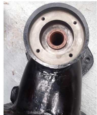
Imagen 53 – Vista inferior del retén en el interior del codo de hierro.
