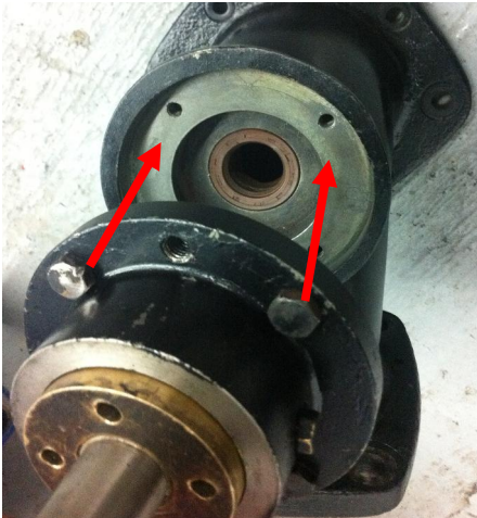
Imagen 113 – Se señala a la base del rodamiento y muestra la forma de acople.
