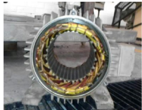
Imagen 82 – Se observa a la base y estator desacoplado.
