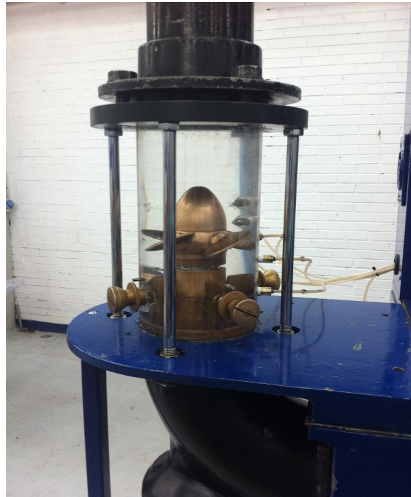
Imagen 104 – Vista del ensamble frontal de la turbina y condiciones finales.
