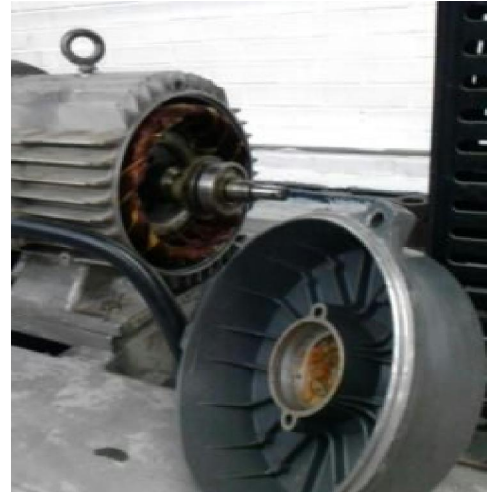
Imagen 81 – Carcaza posterior de la bomba.
