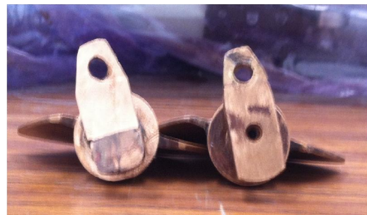
Imagen 80 – Se observa a los álabes reparados.
