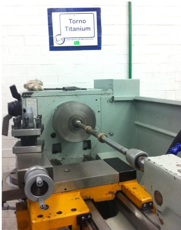
Imagen 76 – Muestra al eje de la turbina montada en el torno aplicando el proceso señalado.
