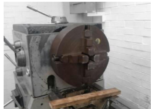
Imagen 84 – Se observa al cabezal de 4 mordazas montado en el torno.
