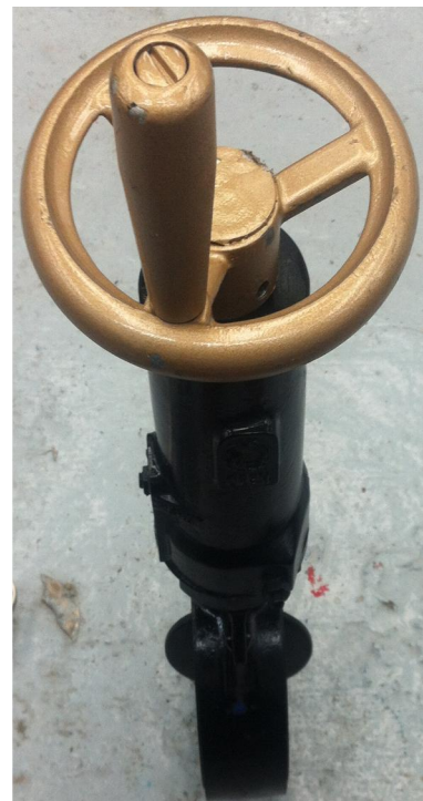
Imagen 5- Muestra una de las tres válvulas fuera del sistema hidráulico después de su rehabilitación.
