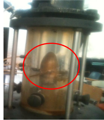
Imagen 10 – Se puede observar el rodete y álabes (círculo rojo) dentro del cubo de acrílico.
