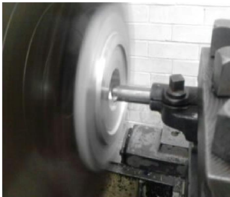
Imagen 87 – Se realiza el corte interno bajo las medidas específicas.
