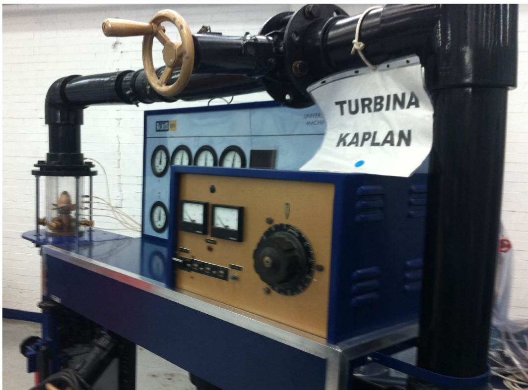
Imagen 108 – Se puede observar a la unidad de control (azul y oro), parte del sistema hidráulico (negro) y el marco de aluminio cómo mejora adicional.
