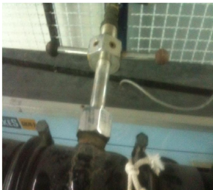
Imagen 32 – Medidor de flujo acoplado a la placa de aforo. .
