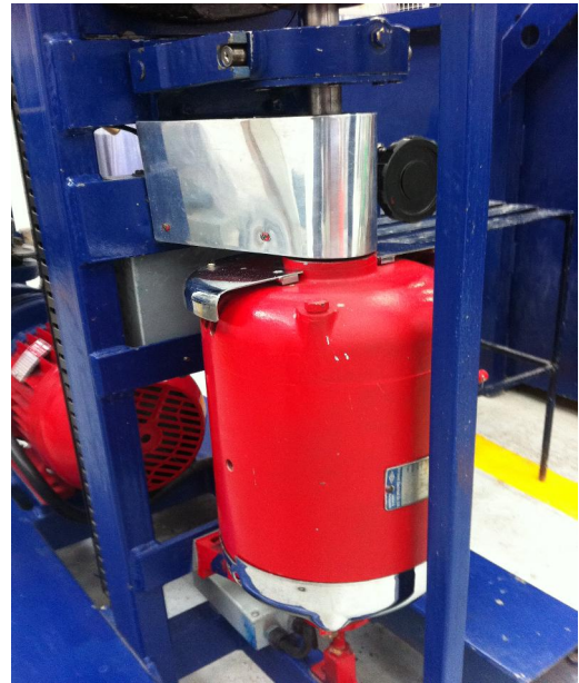
Imagen 107 – Motor / generador (en rojo) y tapas y guarda, aplicado el acabado de cromado.
