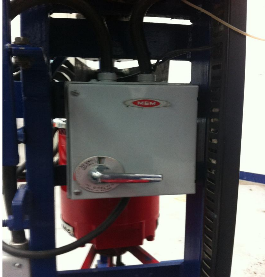
Imagen 109 – Muestra el sitio del aislador principal en el equipo.
