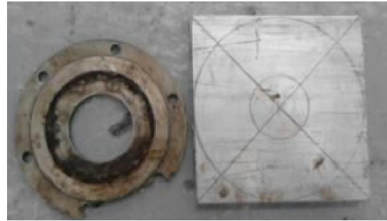
Imagen 67 – Se observa la pieza rota y el material con el que se fabricará (aluminio).
