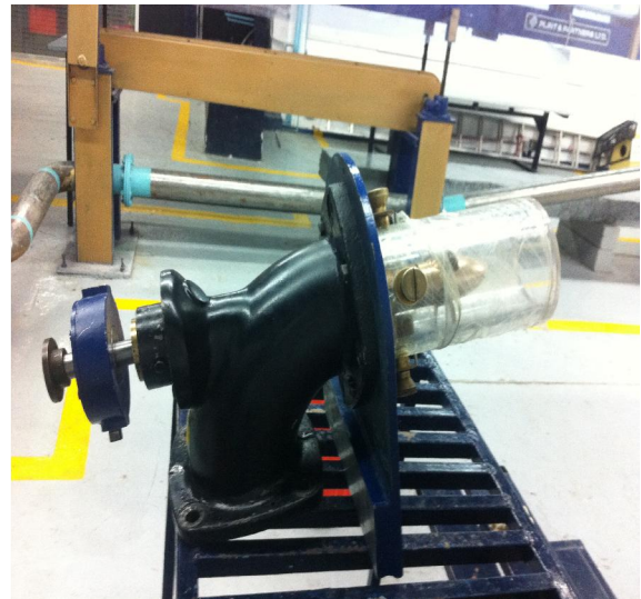
Imagen 112 – Se observa de izquierda a derecha: zapata de acoplamiento, alojamiento de balero, codo, placa horizontal y cubo de acrílico que deben de desacoplarse juntos.
