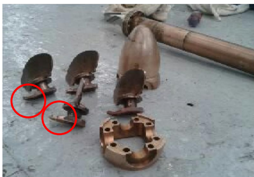
Imagen 40 – Muestra la localización de las rupturas en los alabes y la turbina desacoplada.
