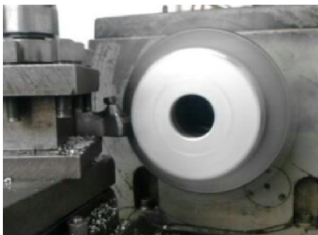
Imagen 88 – Se define el diámetro exterior en la pieza.
