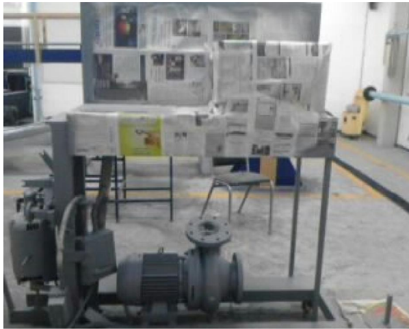
Imagen 98 – Vista frontal del equipo una vez aplicado el praimer.
