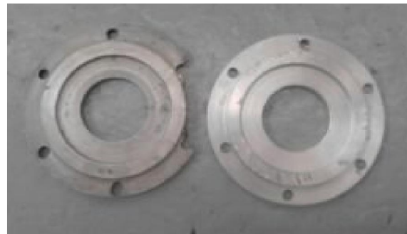
Imagen 92 – Vista interior de la pieza dañada (izquierda) y tapa fabricada (derecha).
