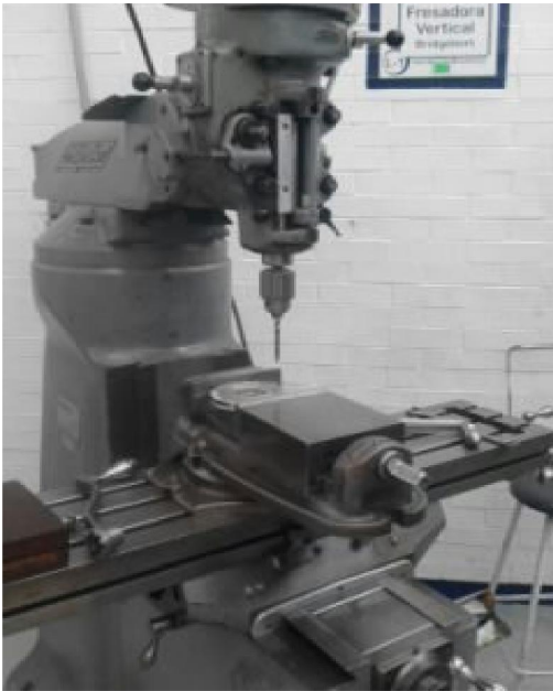
Imagen 90 – Se observa a la tapa montada en la fresadora vertical y herramientas de trabajo.
