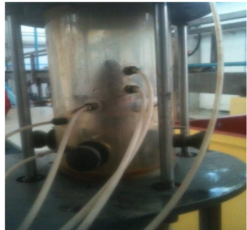
Imagen 46 – Muestra los alabes situados en su sitio en el cilindro de acrílico.
