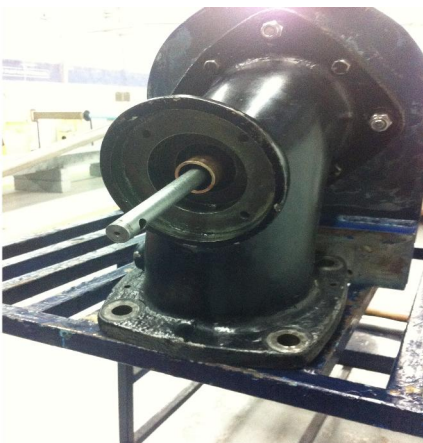
Imagen 115 – Se observa la forma en la que tiene que salir el eje en la parte inferior.
