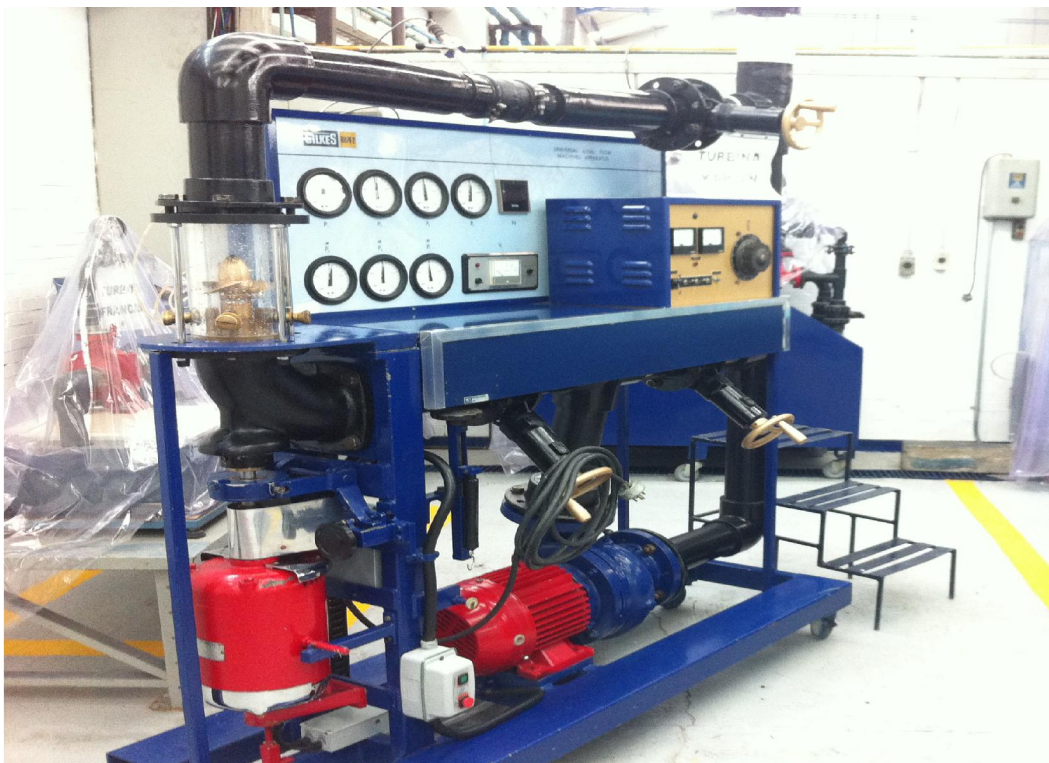
Imagen 105 – Se puede observar a todo el sistema hidráulico (en negro), manómetros y Flujoímetro en panel principal.
