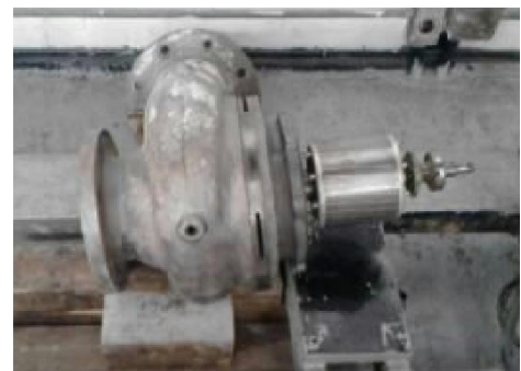
Imagen 83 – Muestra a la voluta y rotor en la etapa de mantenimiento correctivo.
