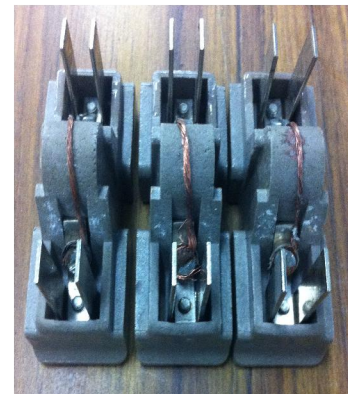
Imagen 75 – Muestra a los tres fusibles con el hilo conductor reemplazado.
