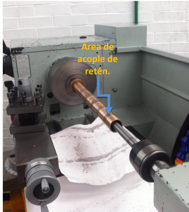
Imagen 78 – Se observa al eje y tubo de bronce montados en el torno y el área del retén.
