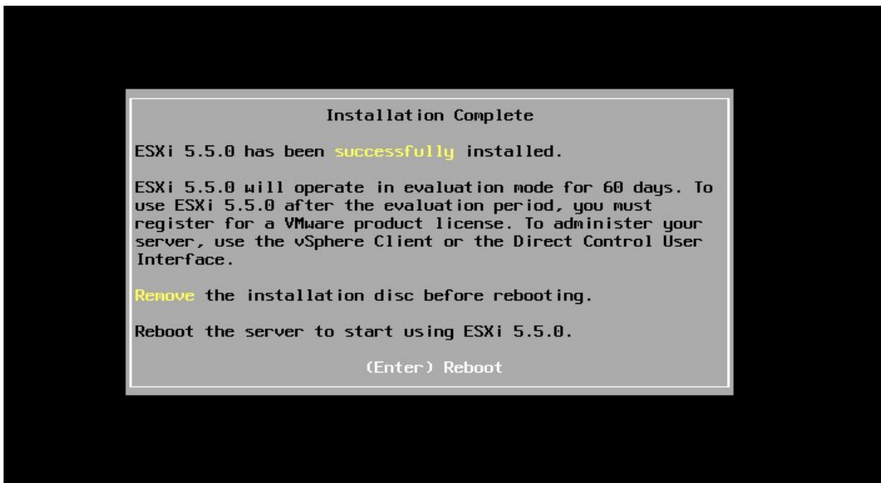
Ilustración 3.1.8: Confirmación de instalación completa
