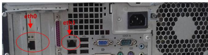
Figura 11.CPU con dos tarjetas de red
