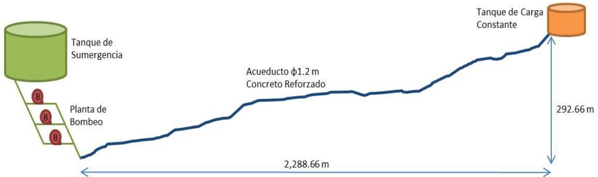
Figura 4.12. Perfil del acueducto a bombeo
