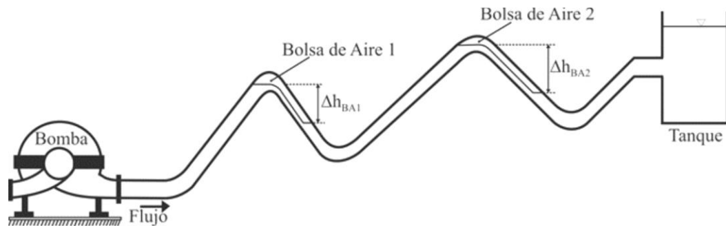
Figura 4.3. Bolsas de aire en acueductos de bombeo (Fuente: Pozos et al.,2012)
