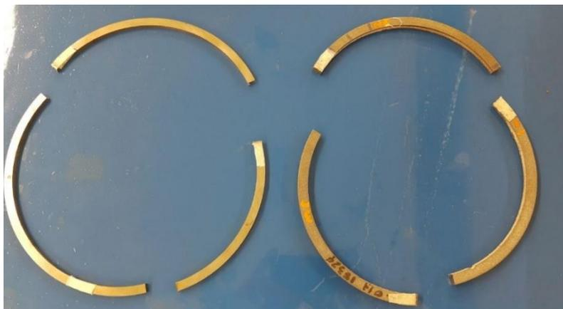
**Figura [4.10] Cortes de los anillos por ángulos. Cada uno contará con 3 probetas más pequeñas de 1[in] y de 1[cm] por cada corte.**
