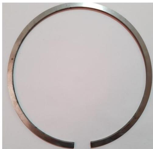
Figura [4.2] Anillo sin costura de fundición centrífuga horizontal.
