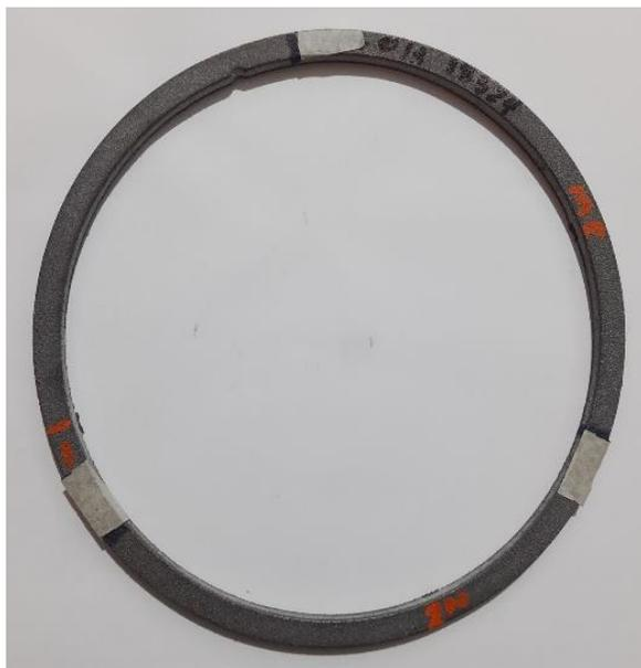
**Figura [4.5] Marcaje para el corte del anillo de fundición de arena a  $120^\circ$ .**
