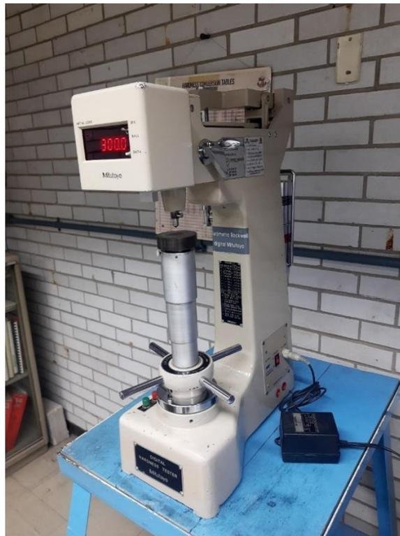
Figura [3.5] Equipo digital para la obtención de dureza Rockwell.
