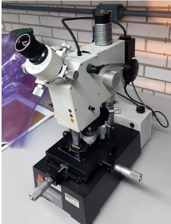
**Figura [3.7] Equipo para la obtención de dureza Vickers.**
