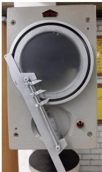
**Figura [5.7] Estación para la toma de la huella.**
