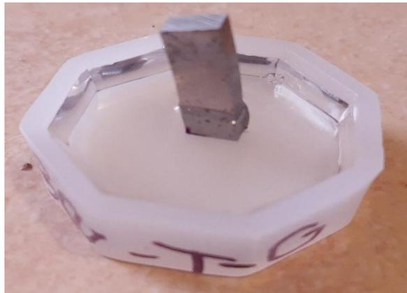
**Figura [4.15] Muestra del anillo obtenido por fundición centrífuga horizontal, dimensión de 1 [in].**
