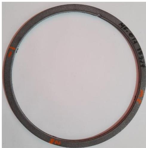
Figura [4.1] Anillo sin costura de fundición de arena.
