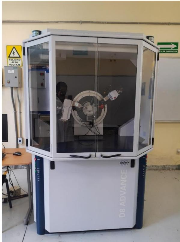
Figura [3.3] Difractómetro de rayos X Modelo D8 Advance de la marca Bruker.
