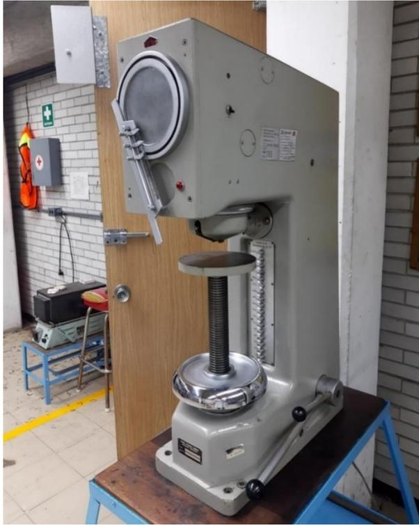
Figura [3.6] Equipo para la obtención de dureza Brinell.
