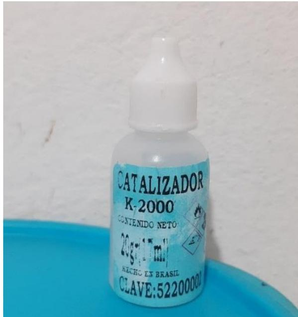
**Figura [4.12] Catalizador (K-2000) usado en la resina poliéster.**
