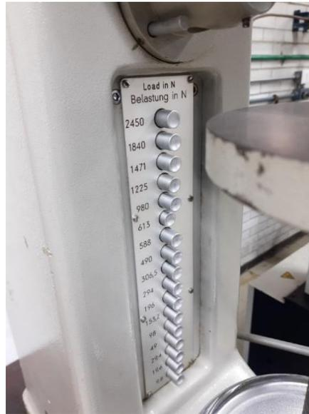
**Figura [5.6] Designación de la carga para el ensayo.**
