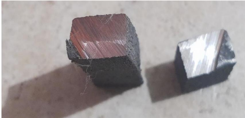
**Figura [4.11] Defectos ocurridos en las muestras durante el corte del anillo de fundición de arena.**
