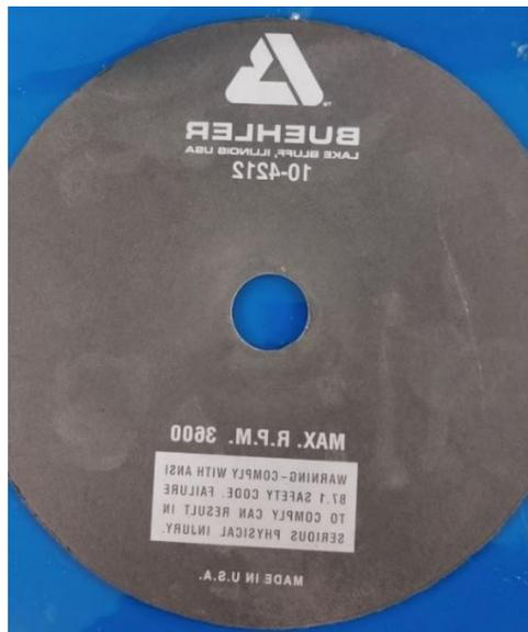
**Figura [4.8] Disco para cortar acero Buehler 10-4212.**
