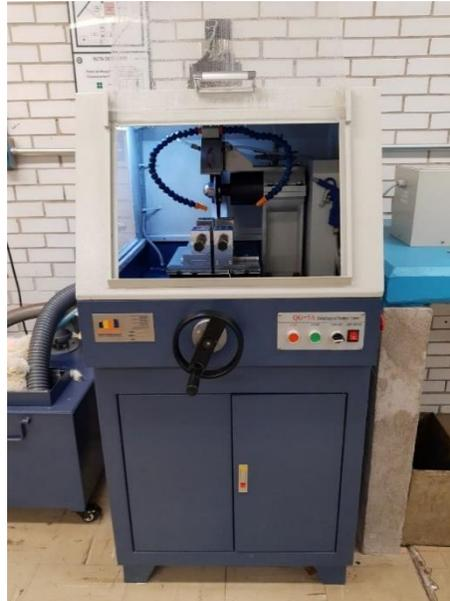
Figura [4.7] Máquina a utilizar para los cortes de las probetas.
