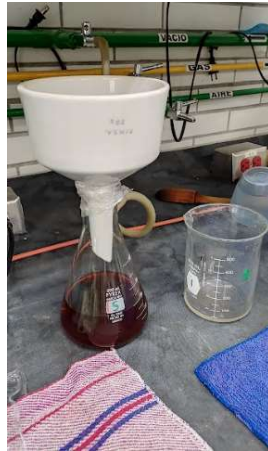
Figura 24. Filtración de muestra con embudo Buchner.
