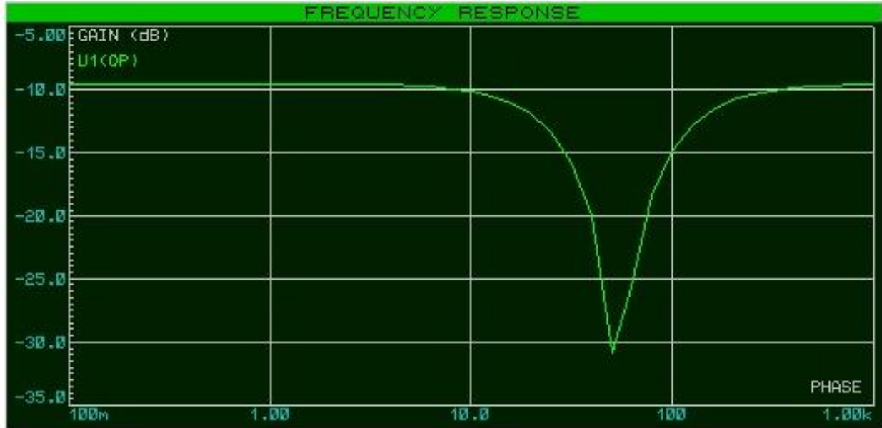
Figura 4. 17. Respuesta en frecuencia del filtro Notch simulado en Proteus.
