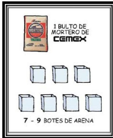
Figura 4.6 Proporciones de arena por bulto de mortero CEMEX tomada del “Manual de Autoconstrucción y Mejoramiento de la Vivienda”
