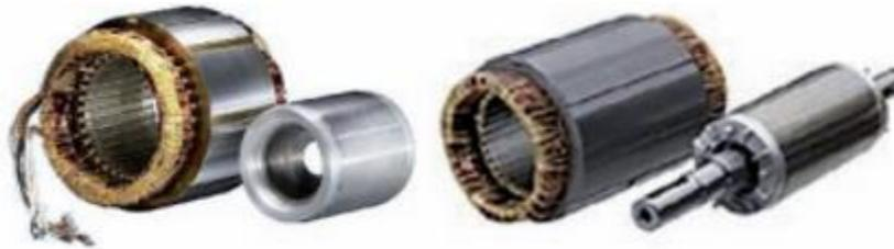
*Estator y rotor del motor eléctrico; figura 4.*
