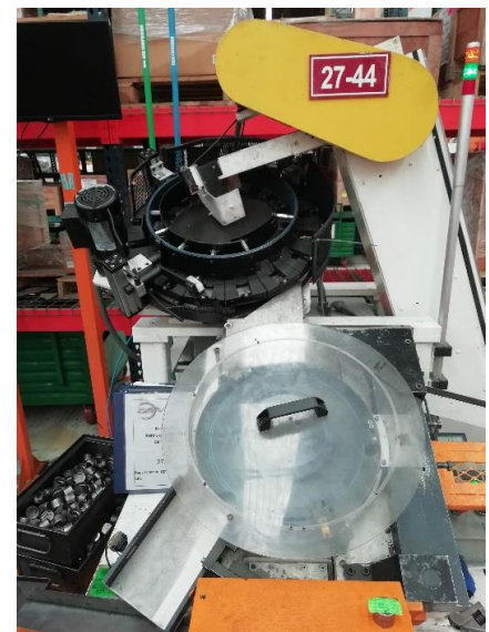
Figura 12. Marcado de Housing en la máquina 27-44
