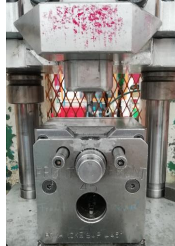
Figura 15. Proceso de Perforado
