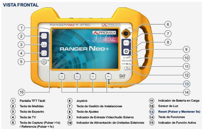
Fig. 2.34 Funciones del Panel Frontal del Medidor (PROMAX, 2019)
