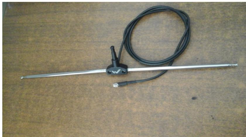
Fig. 4.2 Antena Dipolo Final, sin problema de Conexión
