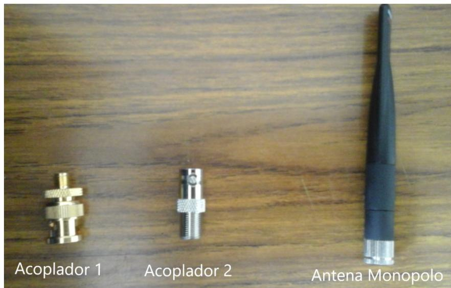
Fig. 3.3 Acopladores y antenna monopolo para colocar en el Medidor de campí.
