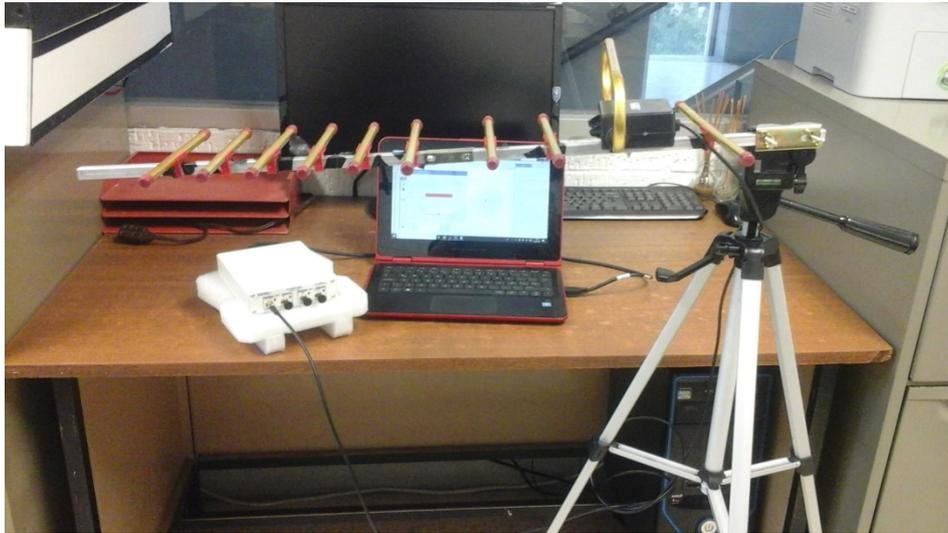
Fig. 3.28 Colocación de la antena sobre el eje del soporte juntos con las conexiones al USRP y a la computadora.
