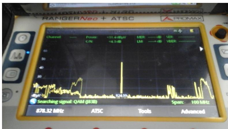
Fig. 4.5 Recepción con la antena Yagi Uda conectada al medidor de campo
