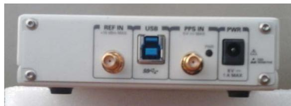
Fig. 3.9 Parte Trasera del NI USRP 2901
