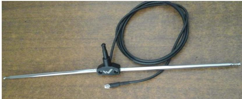
Fig. 3.13 Antena Dipolo Adaptada con cable RG58 y conector SMA
