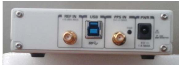
Fig. 2.6 Imagen Física de la Parte Trasera del NI USRP 2901
