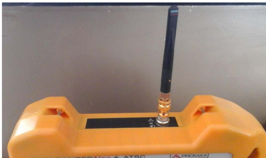
Fig. 3.4 Antena instalada en el medidor de campo
