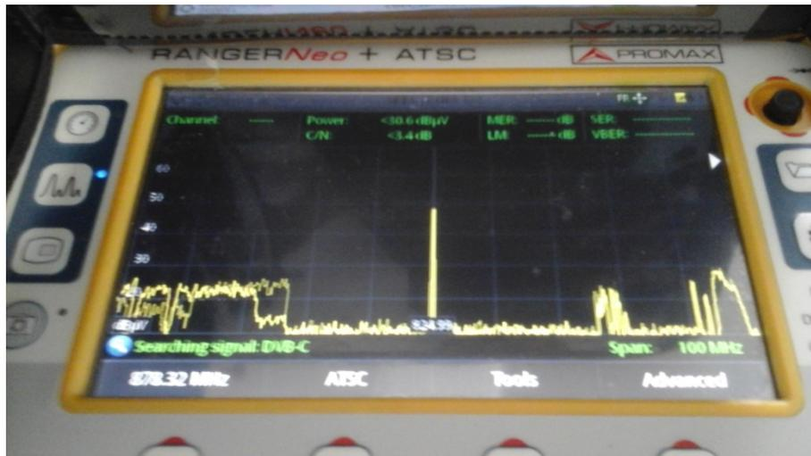
Fig. 4.6 Recepción de la antena Yagi Uda a 0° de ángulo girado.
