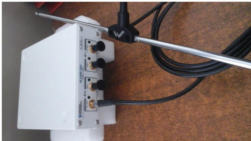
Fig. 3.14 Antena conectada al NI USRP 2901
