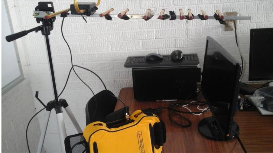
Fig. 4.3 Antena Yagi Uda Conectada al Medidor de Campo
