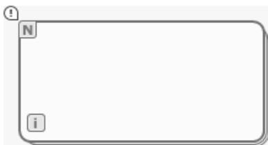
*For Loop.* El código dentro de este bucle se repetirá la cantidad de veces que se especifique en la entrada Loop count. Para este caso, la cantidad de veces que se repetirá el código será la cantidad de grados que se tomen para un solo valor de potencia, en específico, el valor ingresado en el control Cada cuantos Grados.
