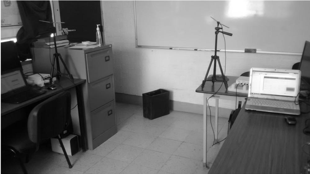
Fig. 3.24 Arreglo Físico de las antenas; Recepción en el lado izquierdo, Transmisión en el derecho.
