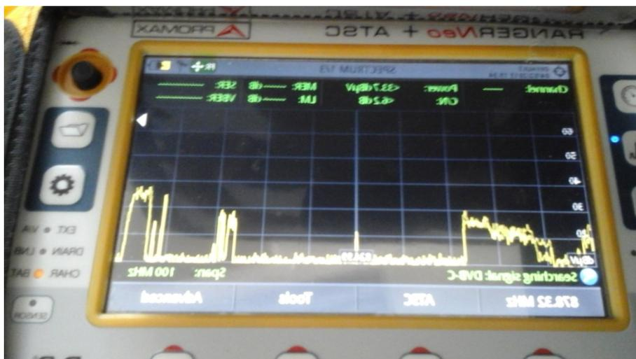
Fig. 4.7 Recepción de la antena Yagi Uda a 90° de ángulo girado.
