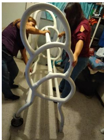
Figura 35. Unión de travesaños a soportes laterales mediante el sistema de broches.
