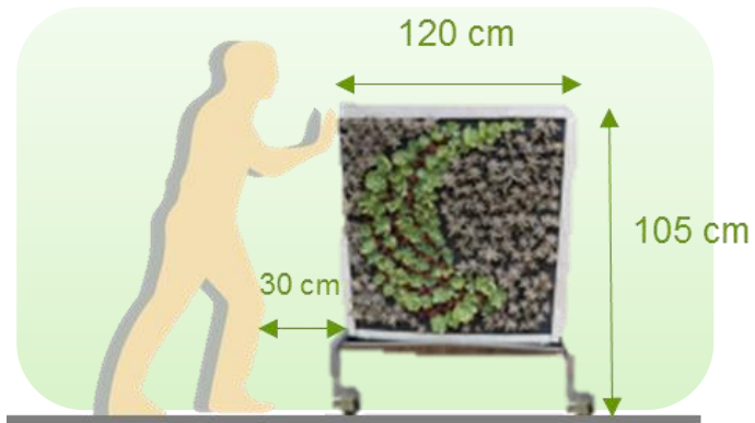
Posición para mover lateralmente muro
