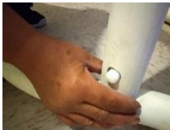
Figura 35. Unión de travesaños a soportes laterales mediante el sistema de broches.
