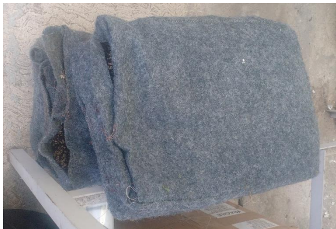
Figura 29. Saco de geotextil estructurado con malla biaxial y relleno de sustrato
