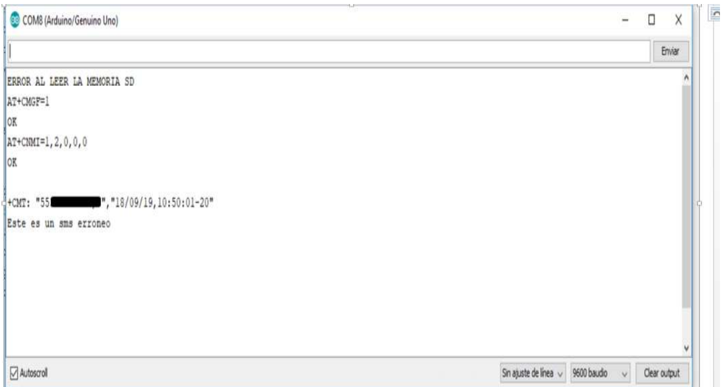
IMAGEN 3.3 EL MONITOR SERIAL MUESTRA EL MENSAJE CON EL SMS QUE RECIBIÓ EL MÓDULO SIM800L
