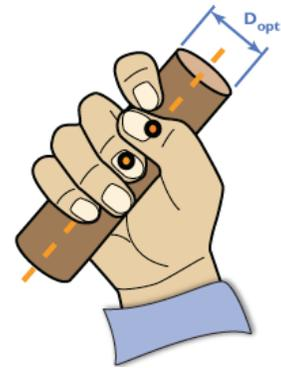
Ilustración 100 Diámetro del mango. Recuperado de: [http://www.ergonomia.cl/eee/Inicio/Entradas/2016/4/17\\_Ergonomia\\_de\\_las\\_herramientas\\_de\\_mano.html](http://www.ergonomia.cl/eee/Inicio/Entradas/2016/4/17_Ergonomia_de_las_herramientas_de_mano.html)
