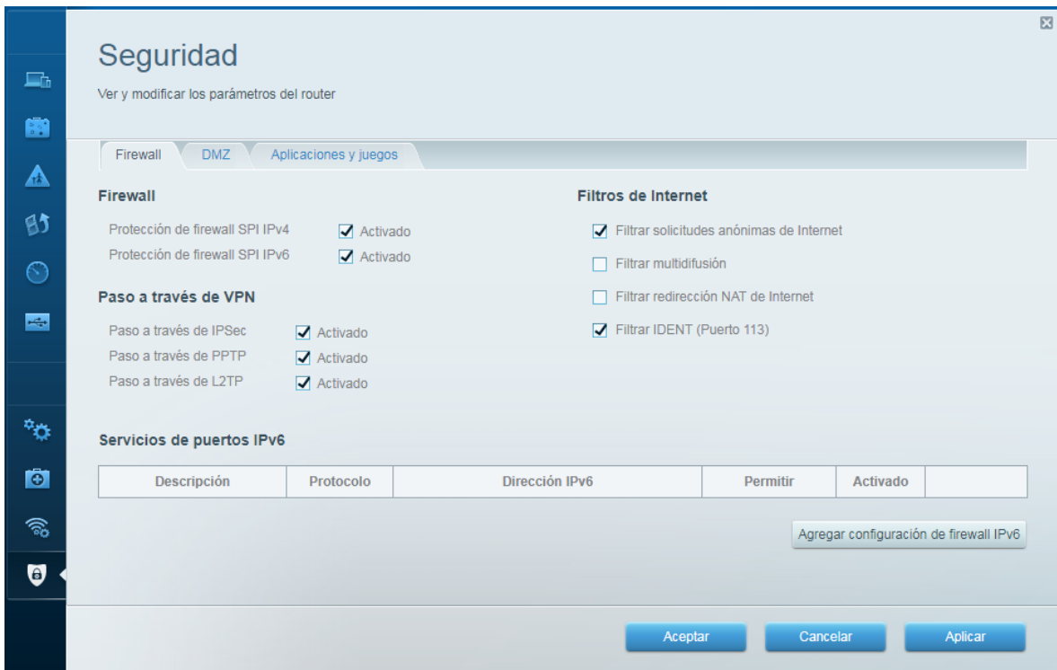
Fig. 3.15. Firewall habilitado para la protección de intrusos.
