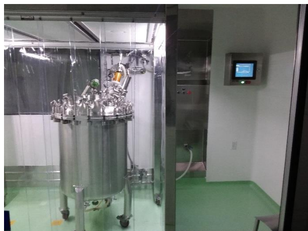
Img. 80 Reactor en reposo bajo flujo laminar de aire filtrado
