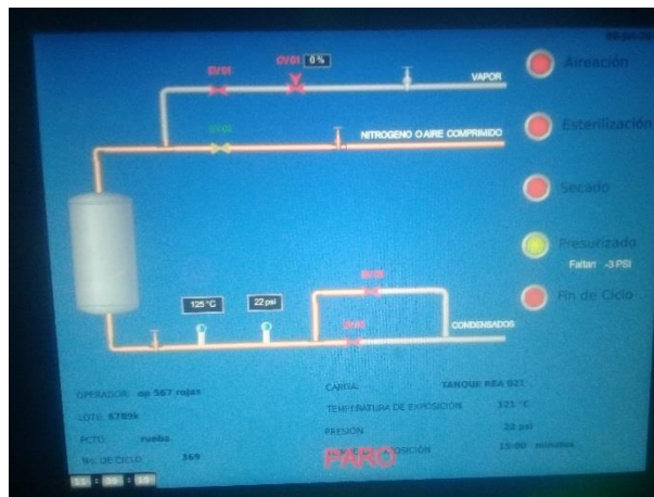
Img. 78 etapa de presurizado.
