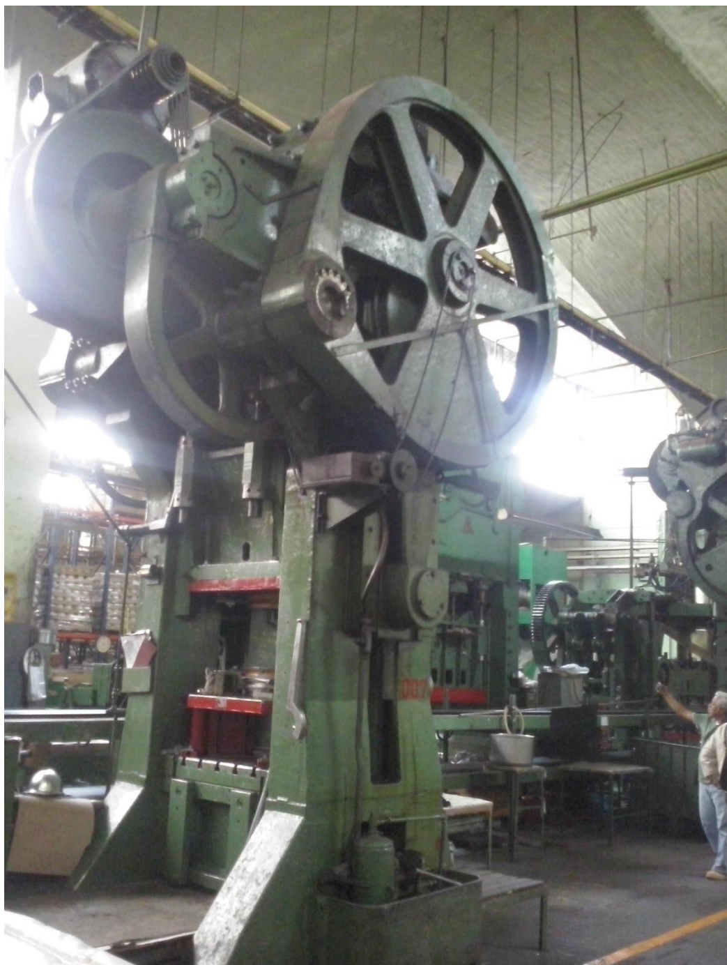
TROQUEL HIDRAULICO ALTURA DE FABRICACIÓN FRANCESA: FICHA TÉCNICA SEGÚN FABRICANTE -ALTO: 6.82 M, - PESO 28.36 TON, - PRECION DE TRABAJO 45.5 TON /CM2 (se utiliza para el moldeado de olla para el cocimiento de alimentos a presión)
