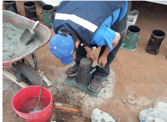
Foto No. 8. Revenimiento
