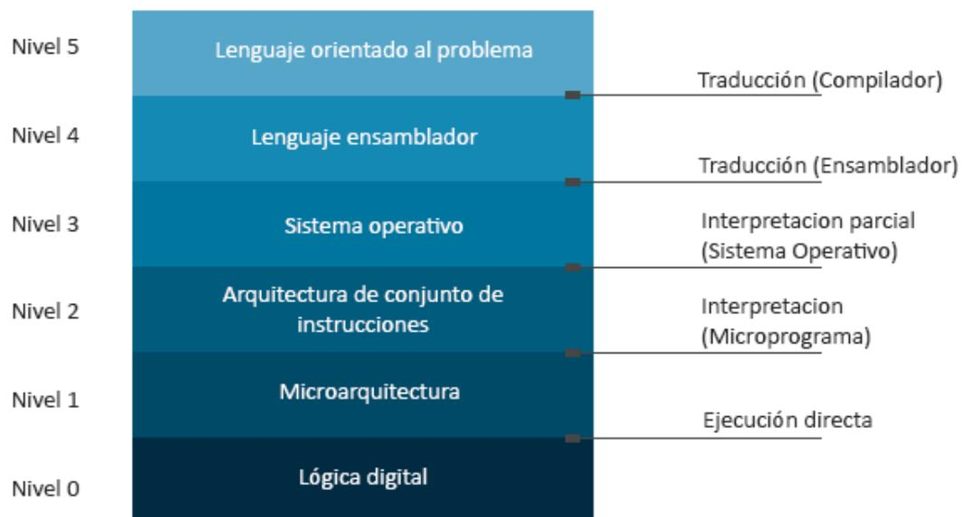
Figura 2.- Diagrama de máquina multinivel, estructura de capas
