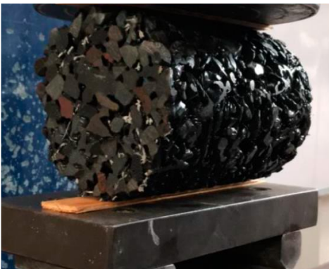
Imagen 15: Cilindro de concreto permeable en compresión
