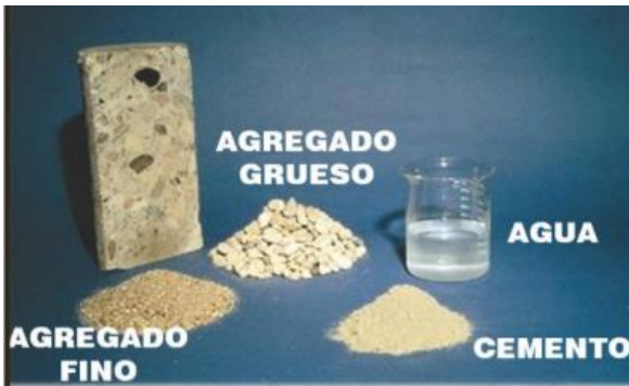
Imagen 11: Materiales del concreto
