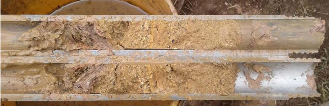
**Fotografía 22.** Muestra alterada sondeada en la parte intermedia del talud
