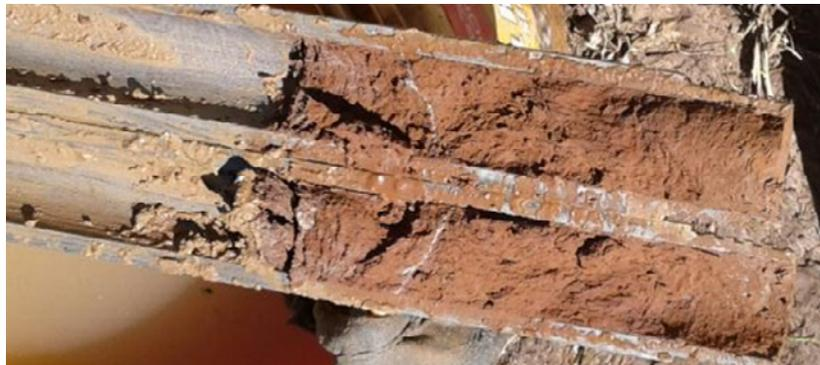
**Fotografía 17.** Muestra alterada recuperada en la parte media del sondeo.
