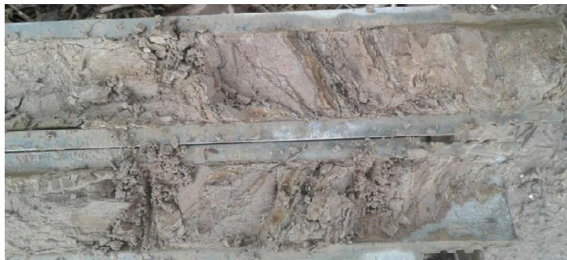
**Fotografía 18.** Muestra alterada recuperada en los últimos metros con tubo partido.
