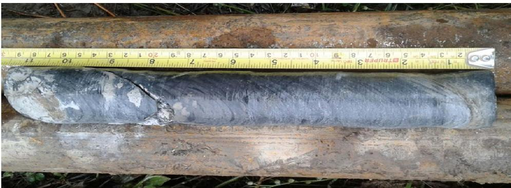
**Fotografía 27.** Núcleo de roca, obtenido con el barril NQ.
