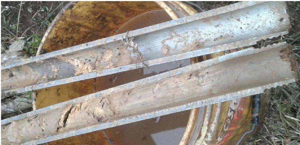
**Fotografía 21.** Muestra alterada, obtenida en los primeros metros de exploración.
