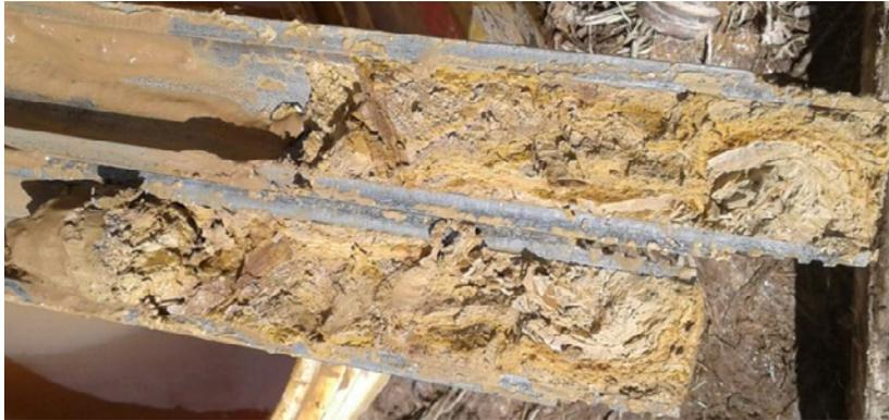
**Fotografía 16.** Muestra alterada recuperada en los primeros metros con tubo partido.
