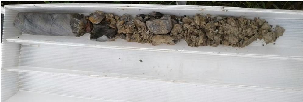
**Fotografía 26.** Muestra alterada, obtenida con el barril NQ.
