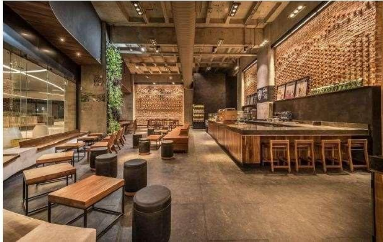
Fig. 31. Fotos de una sucursal CORE. Los gabinetes se fabricaron en MDF con laminado plástico, las cubiertas son de superficie solida Corian y paneles frontales de tzalam
