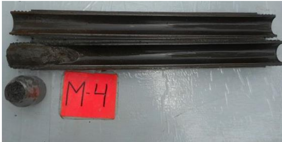
FOTOGRAFÍA 2.13.- MUESTREADOR DE MEDIA CAÑA EMPLEADO
