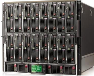
El Servidor con tecnología "blade" ocupado para el ambiente de VMware ESX es un HP ProLiant BL685 G6 para alojar máquinas virtuales con sistema operativo Windows Server 2003 Enterprise SP2 y Red Hat Enterprise Linux 5.
