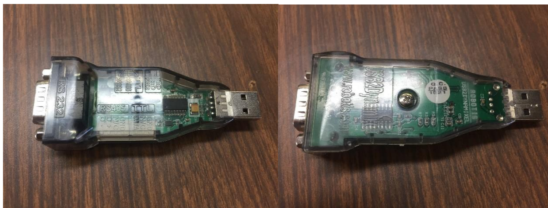
Imagen 5.5 Controlador USB2 para comunicación por puerto USB. [A28]
