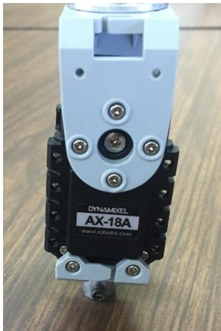
Imagen 5.2 Actuador/Servomotor Dynamixel AX-18A con complementos. [A25]
