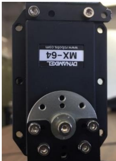
Imagen 5.3 Actuador/Servomotor Dynamixel MX-64 con complementos. [A26]
