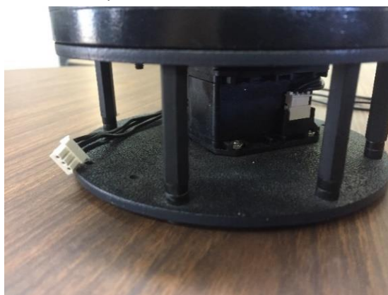
Imagen 5.4 Actuador/Servomotor Dynamixel MX-64 con complementos. [A27] [B40]
