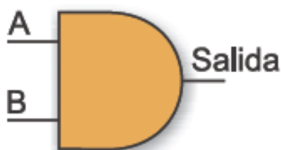
Imagen 1.11 Símbolo de la compuerta AND. [B6]
