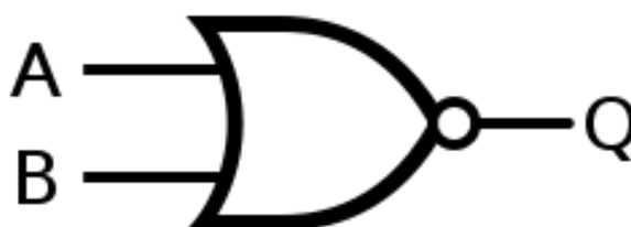
Imagen 1.19 Símbolo de la compuerta NOR. [B10]
