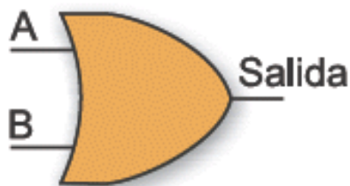
Imagen 1.13 Símbolo de la compuerta OR. [B7]
