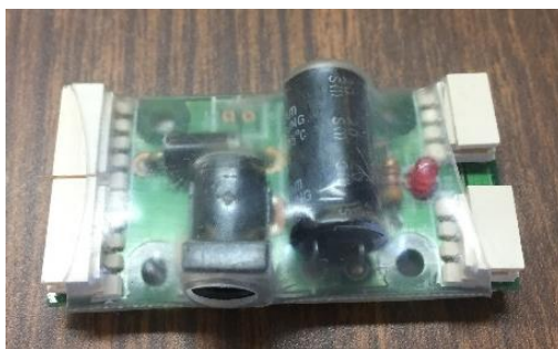
Imagen 5.7 Regulador en el paso de corriente entre el USB2 y los actuadores/servomotores. [A30]
