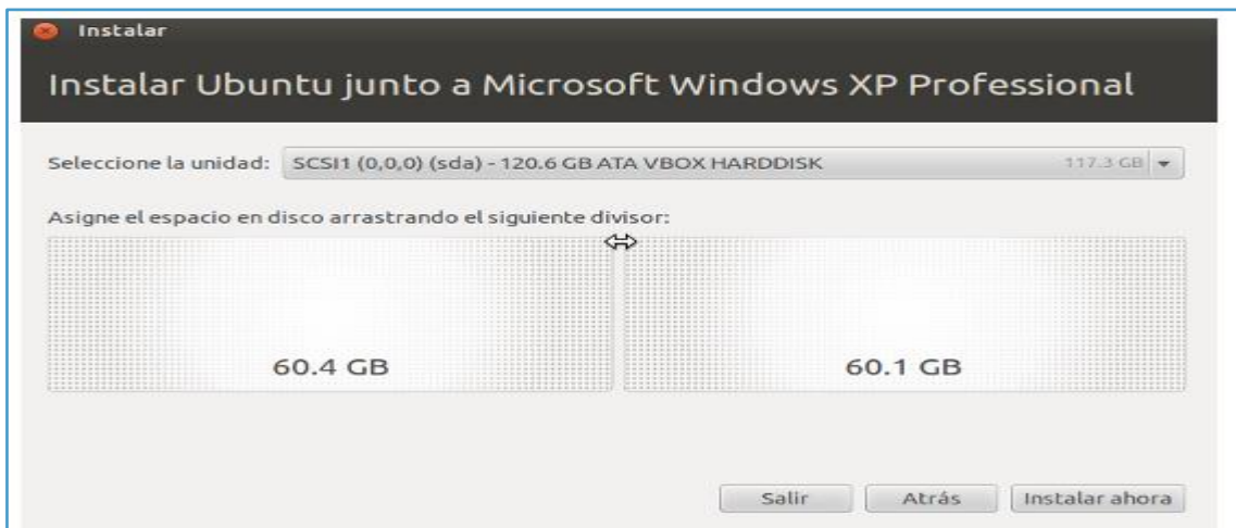
Fig. 4.6. Asignación de espacio en el disco duro, para instalar Ubuntu, junto con Microsoft Windows.
