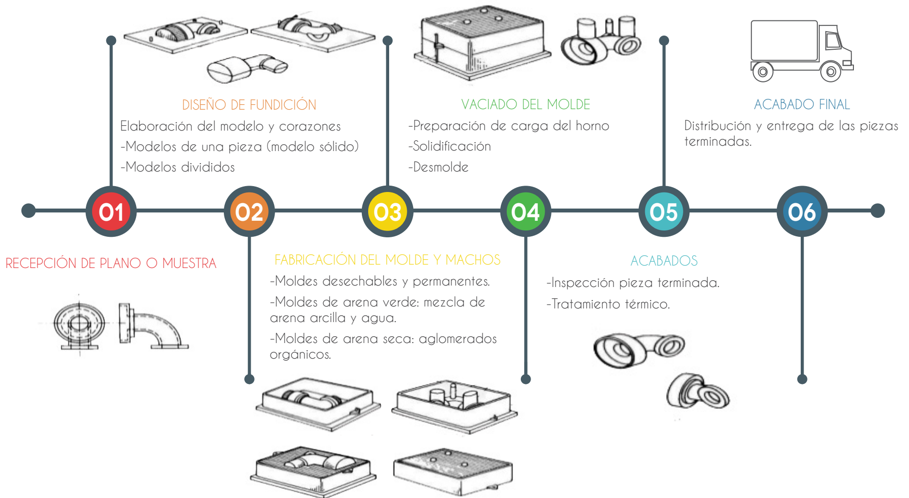
Esquema 3. Infografía del proceso de fundición en arena
