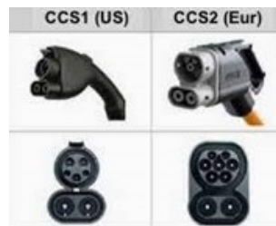
Figura 3.7: Conector Único Combinado (CCS)
