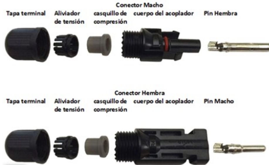
Figura 5.30: Partes que constituyen a un conector MC4. Fuente: Blog CCEEA
