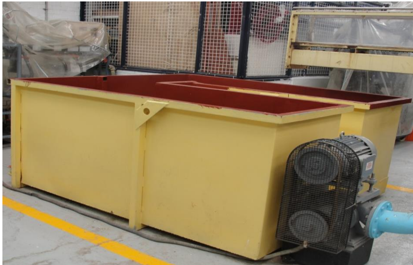
Figura 2.20 Vista lateral del tanque contenedor y la bomba hidráulica.
