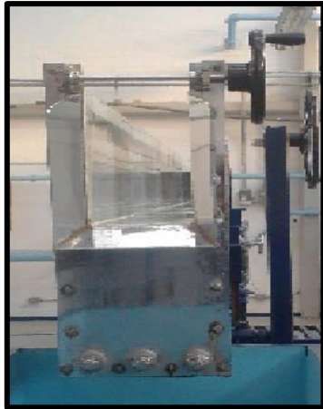
Figura 3.11 Compuerta con manivela montados en el CFU.
