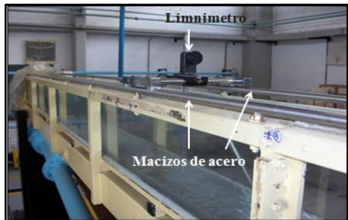
Figura 2.4 Esqueleto de la sección I con los macizos de acero inoxidable en la parte superior y el Limnómetro instalado.
