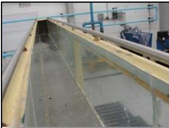
Figura 2.6 Sección de trabajo, énfasis en las paredes laterales constituidas por cristal y la plantilla hecha de acero con un acabado espejo de pulido.
