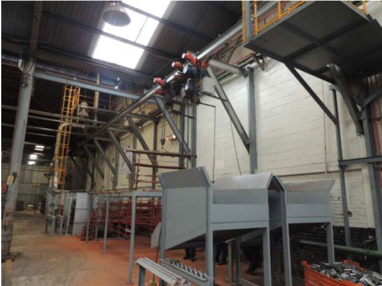
Figura 3.11.- Línea de pintura con sistema de barra conductora implementado
