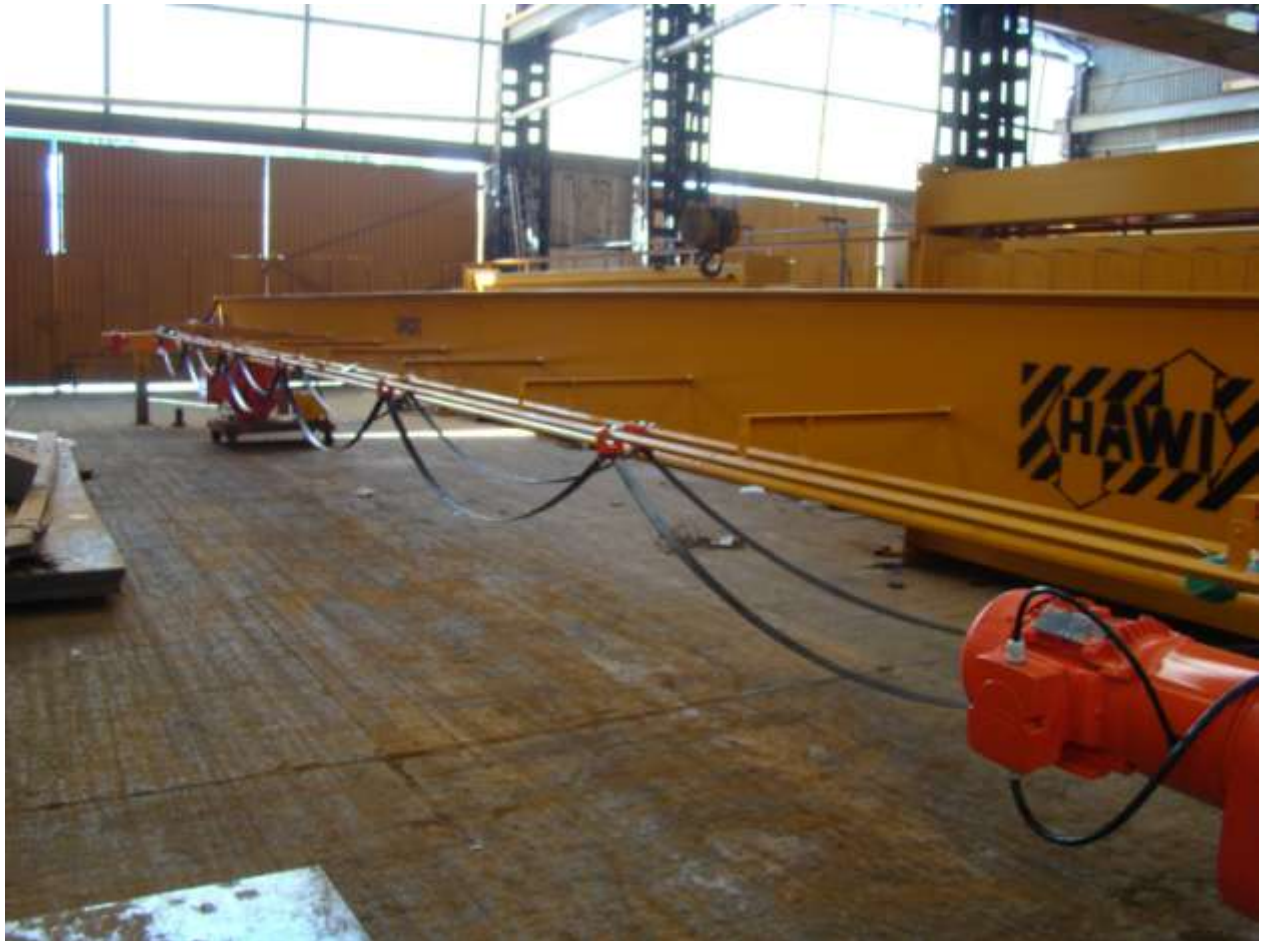
Figura 3.6.- Inspección final de grúa de 5 t en instalaciones de HAWI®, antes del trasporte e instalación.
