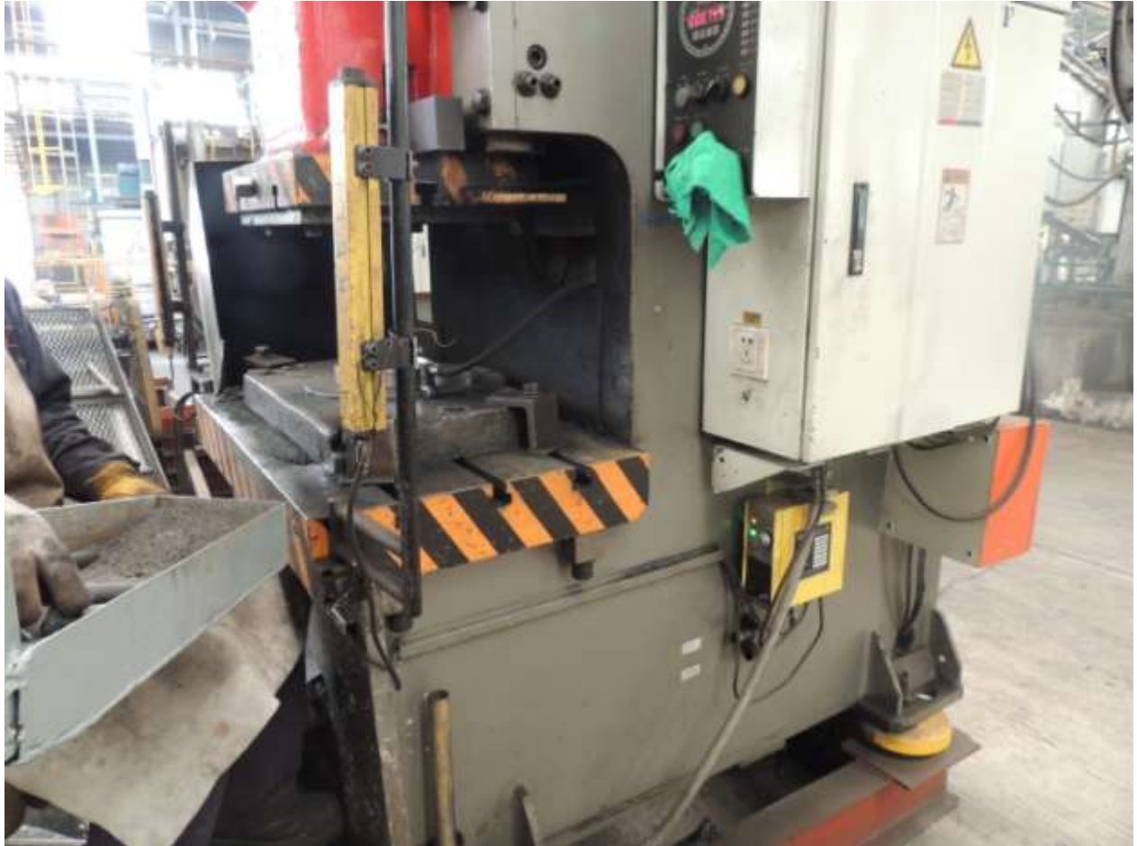
Figura 4.8.- Prensa mecánica tipo C 80 t para desbarbe de material, con sistema de seguridad instalado.
