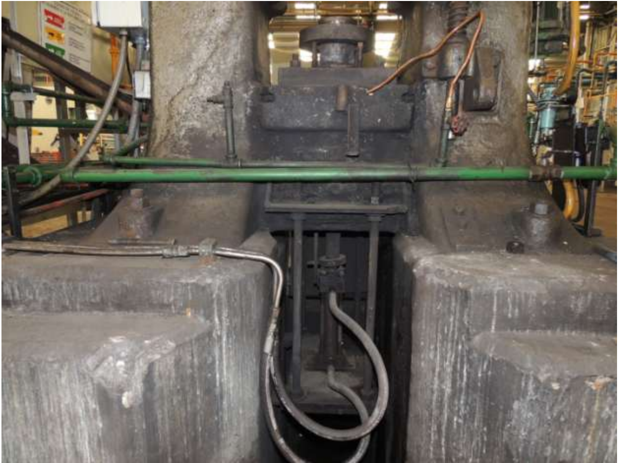
Figura 4.5.- Cilindro hidráulico con sistema de guía en prensa BLANCH
