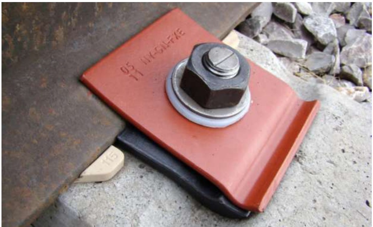
Figura 1.2.- Ensamble de sujeción elástica GN en vía
