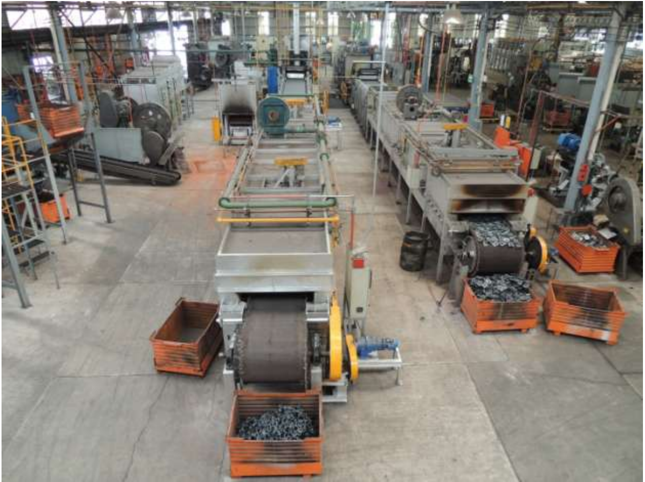
Figura 5.7.- Línea de temple y revenido de ancla a la izquierda y línea de temple y revenido de grapa a la derecha.
