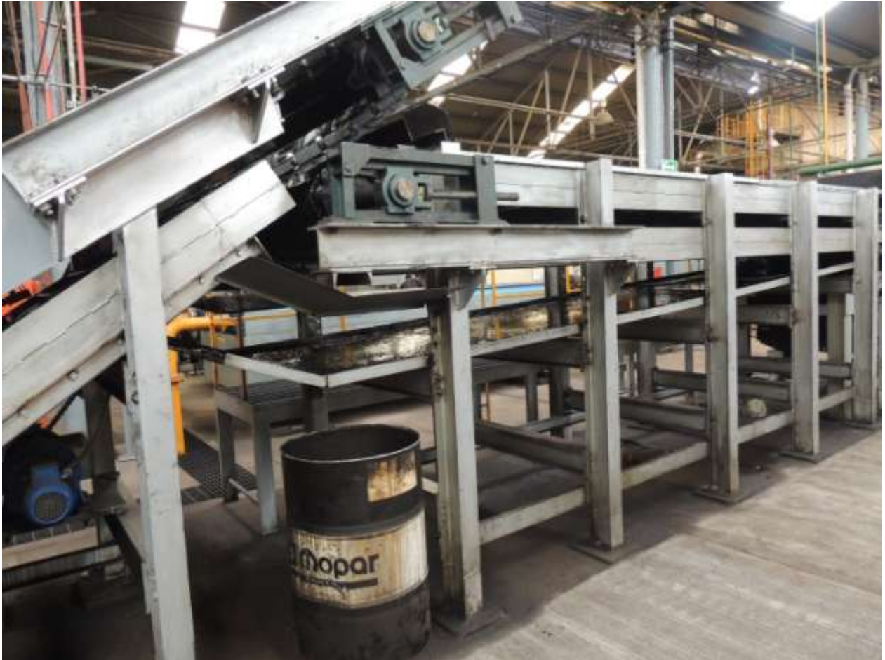
Figura 5.4.- Transportador horizontal de lavado con charola recolectora de aceite.
