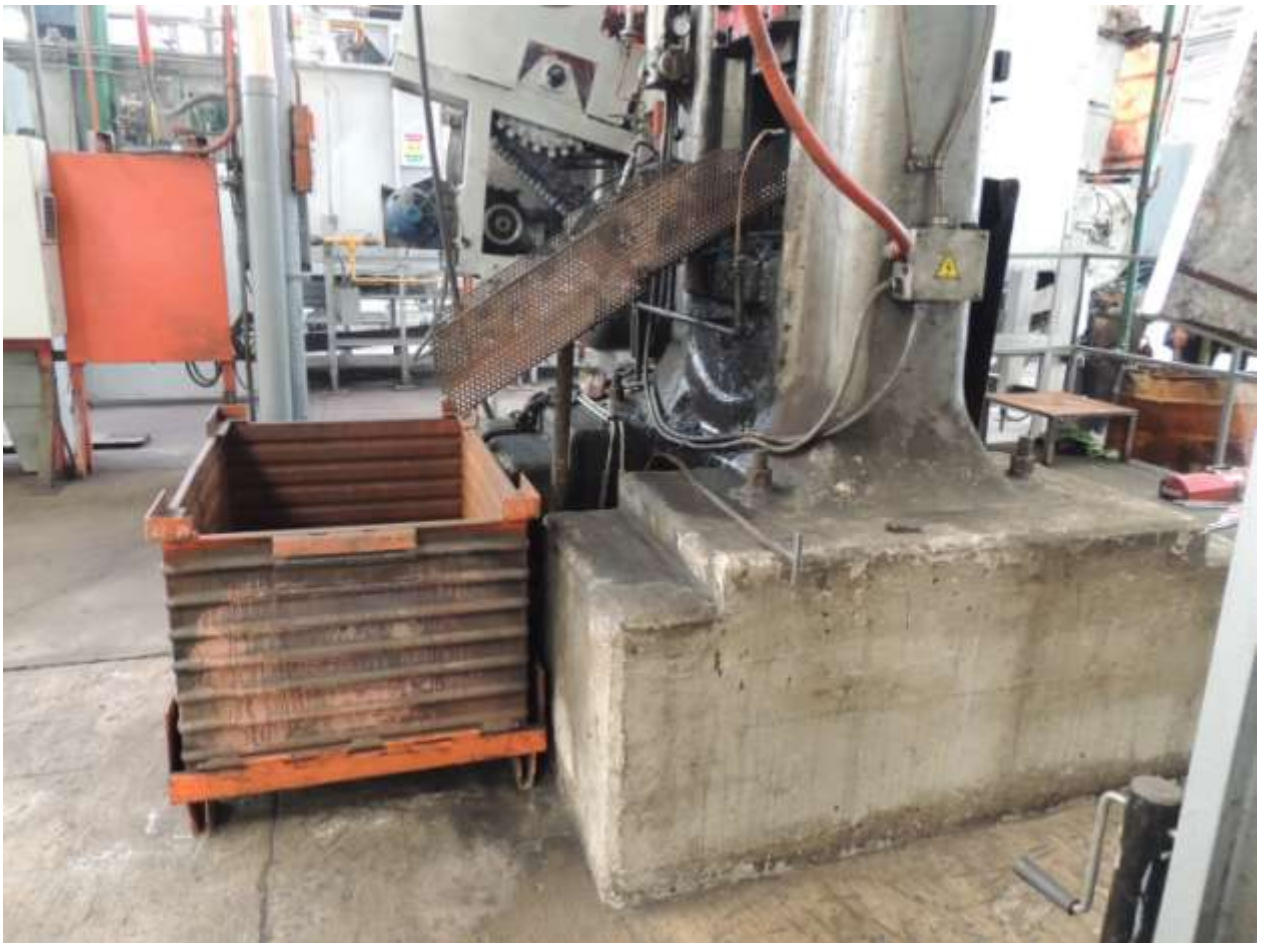
Figura 4.2.- Prensa NOVAEPRESS de 160ton y tolva de caída hacia contenedor.
