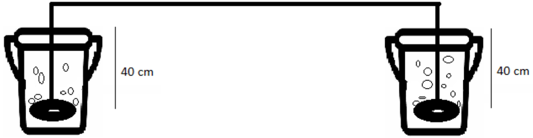
Figura 7. Esquema del acomodo de los anillos difusores para la prueba de SOTR.
