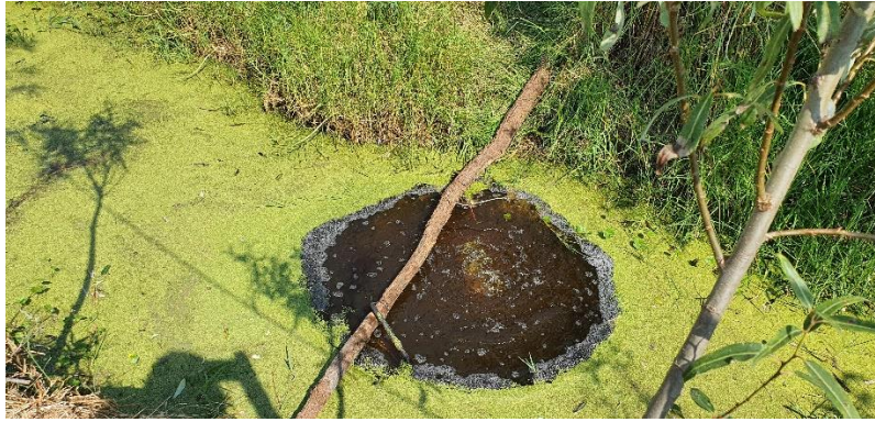
Figura 14. El aire al salir por los difusores provocaba el desplazamiento de L. minor en la superficie, dejando expuesta esa área circular del espejo de agua.
