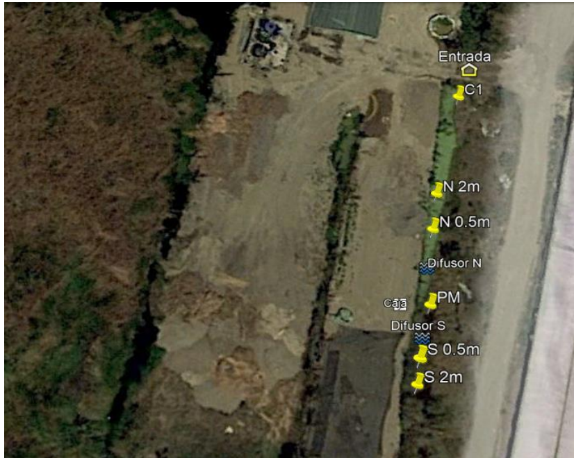
Figura 3. Puntos de medición y muestreo del canal con aireación: N 0.5m = 0.5 metros al norte del difusor Norte (difusor N); N 2m = 2 metros al norte del difusor N; S 0.5m = 0.5 metros al sur del difusor Sur (difusor S); S 2m = 2 metros al sur del difusor S; PM = punto medio
