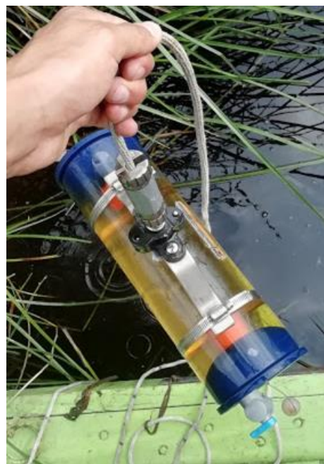
Figura 9. Medición de parámetros FQ con sonda a la mitad del cana, y, muestreo de agua con botella van Dorn
